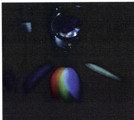
Figura 3.8- Fotografia da rede de difracção do SPATRAM e da decomposição da luz branca que ela provoca.
