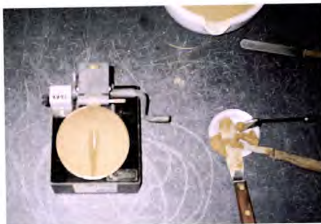
Foto 6.21 – Limite de Liquidez – realização do ensaio de solo na Concha de Casagrande. Situação de um dos ensaios de solos às “25 pancadas”.
