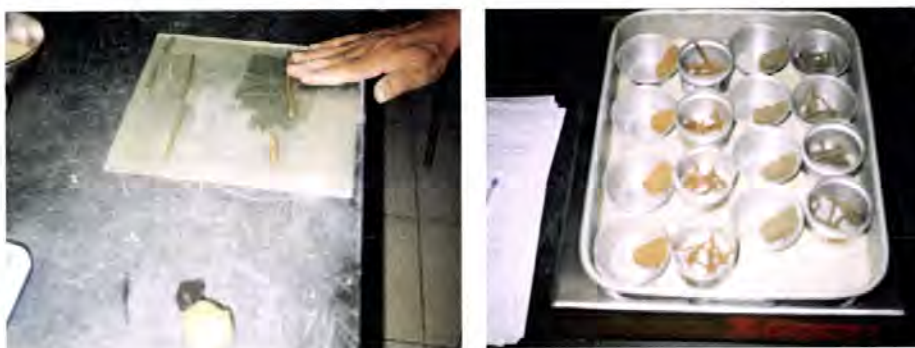
Fotos 6.22 e 6.23 – Aspectos da técnica de ensaio para determinação do Limite de Plasticidade. No tabuleiro o material de dois solos dividido em quatro fracções, pronto para ir à estufa.
