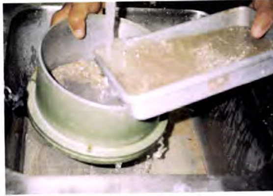
Foto 6.19 – Após demolhada, a amostra integral é passada no “peneiro 200” (ASTM), após o que é seca e submetida aos diversos peneiros para determinar as diversas granulometrias da fracção grossa desse solo.
