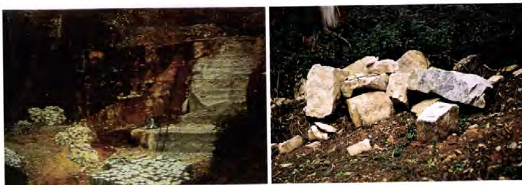
Fotos - 7.3 e 7.4 – Portunhos e Fornos . A extracção de pedra numa pedreira da região de Cantanhede (Foto Carlos Gregório). Foto 7.4 - Aspecto de calcários cremes e cinzentos do tipo dos utilizados na produção tradicional de cal extraídos numa pedreira junto à estrada das pipas, nas imediações de Fornos.
