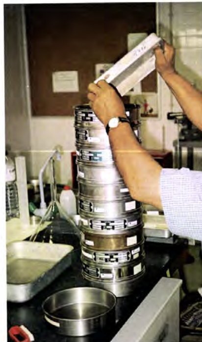
Foto 6.17 / Quadro 6.6 – Colocação de amostra nos peneiros. Quadro de referência dos peneiros ASTM utilizados no presente estudo e dos calibres dos respectivos crivos.
