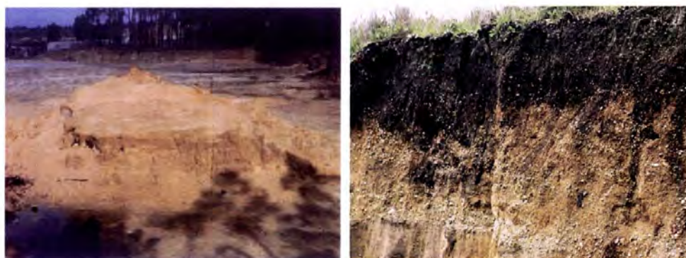
Foto 8.16 – Esgueira, Aveiro. Areias para a produção de adobos. Foto: Artur Leite. Foto 8.17 – Esgueira, Aveiro. Fora da zona de extracção tradicional “...as areias começaram por apresentar já algum «bicho»”, seixo de pequeno calibre muito concentrado no solo, tornando este tipo de terras desadequadas como material de construção. Fonte: Aurora Leite 46 .
