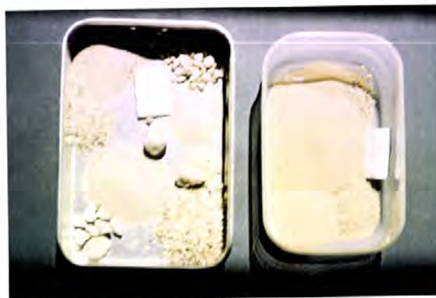
Foto 6.20 – Aspecto das diversas fracções de dois tipos de solos, retidas nos diferentes peneiros, juntas após a determinação das respectivas massas.
