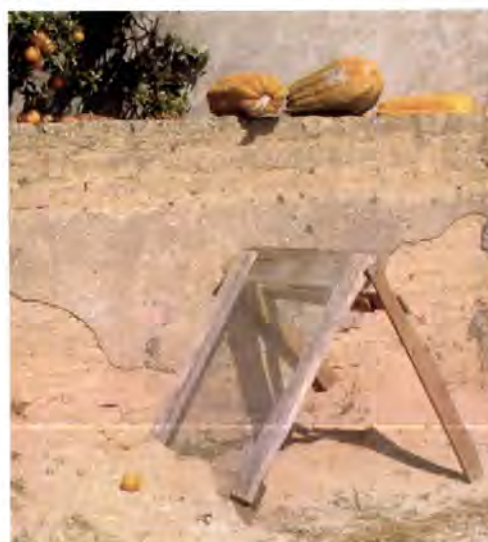
Foto 10.47 – Montinho, Cantanhede. Crivo para remover os inertes de dimensões indesejáveis das areias destinadas a rebocos.
