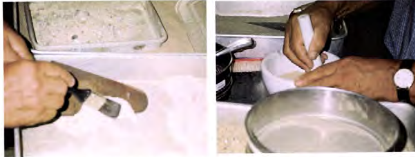
Fotos 6.15 e 6.16 – Primeira fase da preparação. Recolha de porção para análise e desagregação do material com recurso a um almofariz e pilão.
