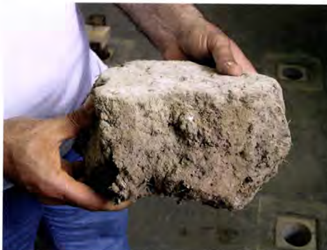
Foto 8.1 – Aveiro. Amostra de parte de um adobo de terra (Universidade de Aveiro, Dep. Eng. Civil).
