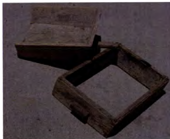
Foto 8.8 – Esgueira. “Coxo” e a “fôrma” de “adobo de parede” (medida interior – 45x28x12cm) O “coxo” está cortado. Originalmente era do comprimento do molde.
