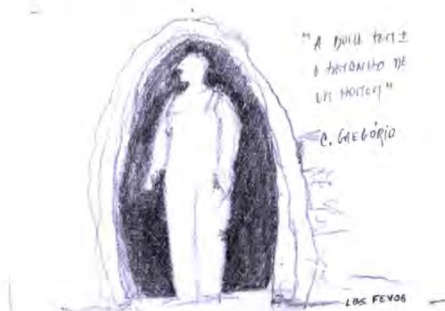
Fig. 7.2 - Nos fornos tradicionais da região a “boca” apresentava uma dimensão pouco maior que um homem, o mesmo se verificando quanto à altura da câmara de combustão.
