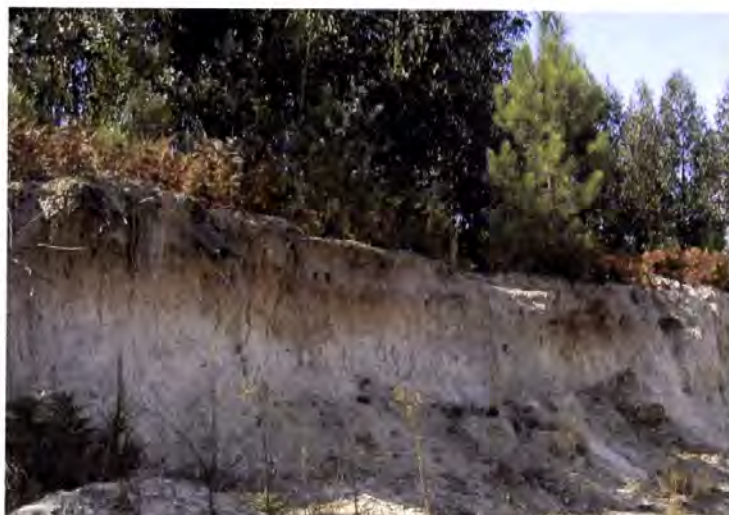
Foto 5.5 – Vale de Ílhavo, Ílhavo. Dunas antigas. Estratificação de um perfil típico de um solo Podzol, com um horizonte A muito reduzido e escuro, o horizonte E cinzento claro e o B com surraipa concrecionada, em tons de castanho, característico do sistema dunar interior, mais antigo.
