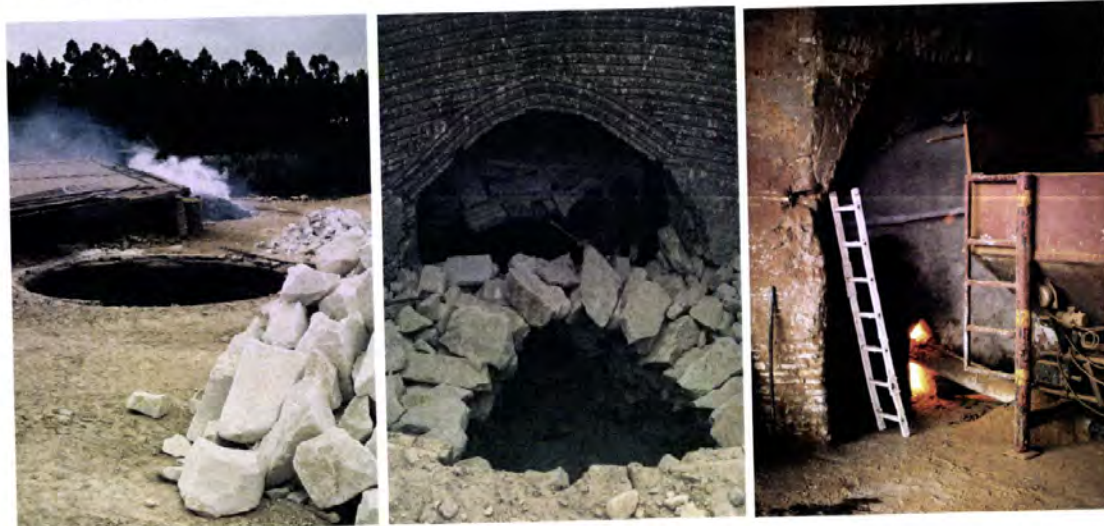
Fotos 7.12, 7.13 e 7.14 – Fornos, Cantanhede. Aspectos da preparação do carregamento, do armar da câmara de combustão (Foto 7.13) e da queima num forno contemporâneo de tipo tradicional (Foto 7.14), explorado por Rui Barreto na localidade de Fornos. Na região de Cantanhede actualmente já não se recorre à calcinação de rochas locais, sendo o calcário utilizado (Foto 7.12) proveniente da Serra dos Candeeiros, uma vez que permite a obtenção de uma cal aérea mais pura.
