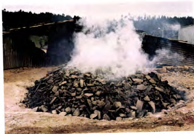
Fotos 7.10 – Fornos, Cantanhede. Forno em combustão. Aspecto do topo do forno durante o processo de calcinação num dos fornos de Rui Barreto.
