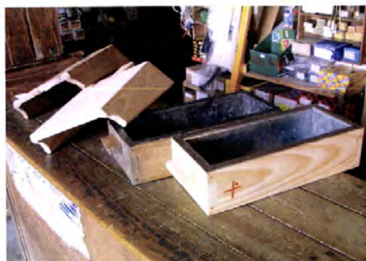
Foto 8.9 – Esgueira. Coxos e formas individuais de “adobo de muro”. Originais utilizados por Bernardino da Silva Madaleno e réplicas do autor.
