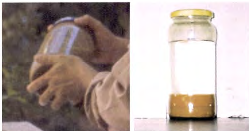
Fotos 6.10 e 6.11 - Ensaios de sedimentação simplificada.
