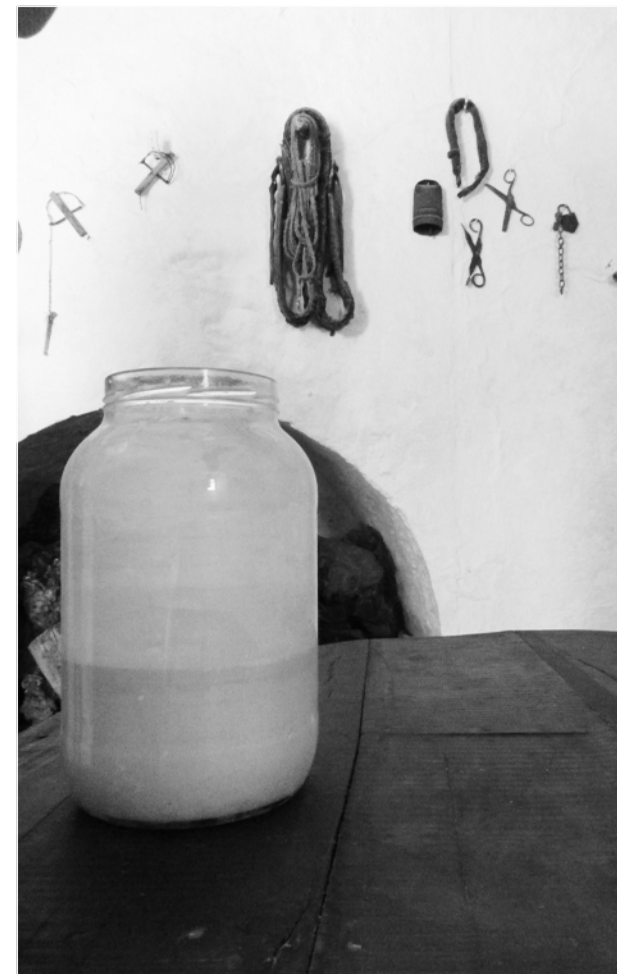
Figura 182: Pormenor do frasco de vidro, na antiga casa musealizada do mestre caleiro, cheio com água e pasta de cal. Las Caleras de la Sierra, 2015.
