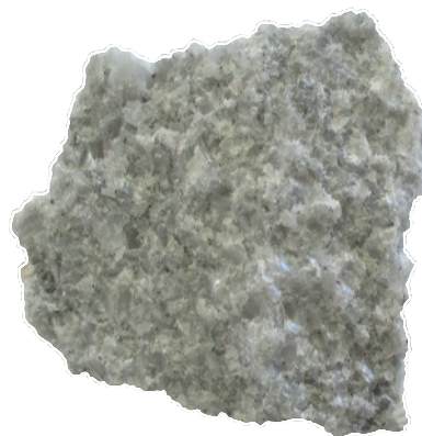
Figura 37: Rocha carbonatada metamórfica - mármore de cal branca de Trigaches, indentificado pelo mestre Jacinto Figueira.
