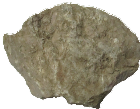
Figura 36: Rocha carbonatada sedimentar - calcário de cal branca de Santa Rita, indentificado pelo mestre António Brito.
