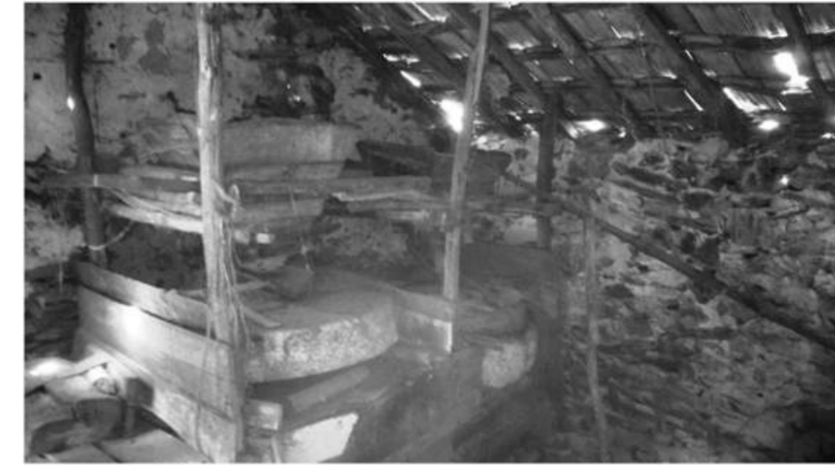
Fig. 80 - Os dois sistemas de moagem presentes no sobrado em que apenas funciona o da esquerda
