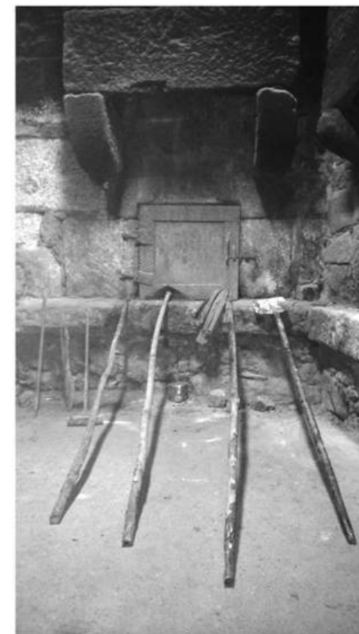
Fig. 56 - Forno grande com os instrumentos: paus das brisas, ferrapo das cinzas e pá do piso
