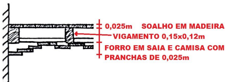
Figura 29 - Piso em madeira com teto em "saia e camisa"
