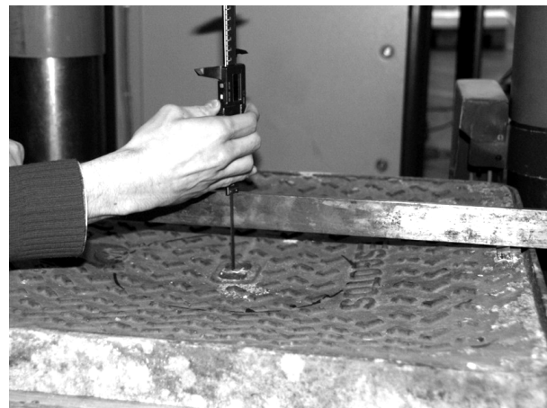
Figura 15 - Deformação de T3 sujeita a 315 kN
