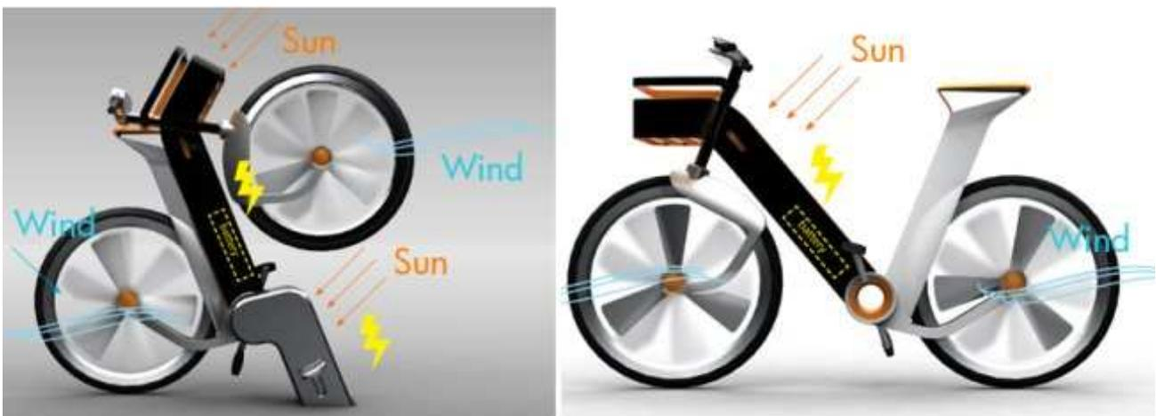
**Figura 50** – Imagem esquemática das bicicletas propostas: Fotografia à esquerda representa a bicicleta posicionada na estação onde será descarregada e simultaneamente captada, a energia; Fotografia à direita representa a captação de energia da bicicleta parada fora da estação. (Adaptação de imagem com base em [http://www.soitu.es/soitu/2009/03/17/hartosdelcoche/1237300638\\_811769.html](http://www.soitu.es/soitu/2009/03/17/hartosdelcoche/1237300638_811769.html))
