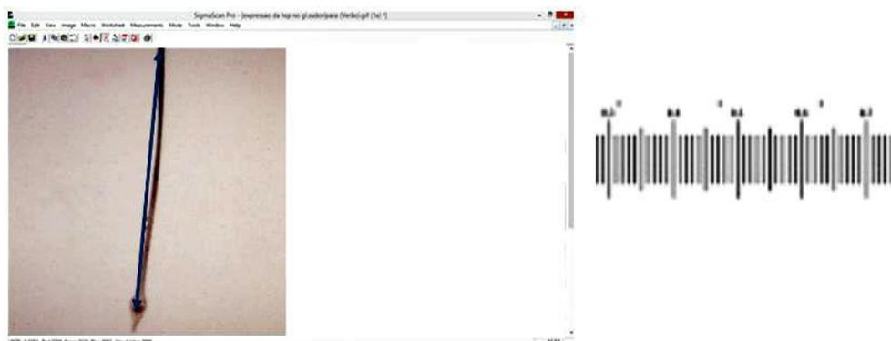
*Figura 17. Medição do comprimento dos pelos e utilização da régua micrométrica para medição do diâmetro*
