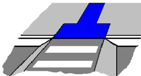
Figura 5.45 - Pavimento tátil de alerta em travessias pedonais elevadas Fonte: (ACAPO, 2011, p. 11)
