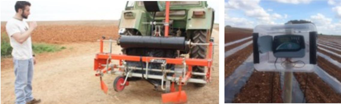
Imagem 96 e 97: respetivamente: trator com alfaia para colocação de *film* e *rapper* para colocação de tubos internos; programador. Fonte: EPCA
