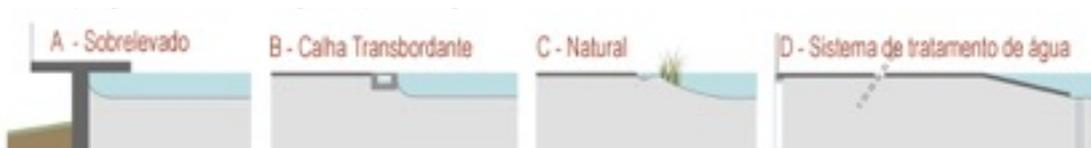
Imagem 58: Esquema de tipos de remate da margem do lago. Sem escala. Fonte: EPCA
