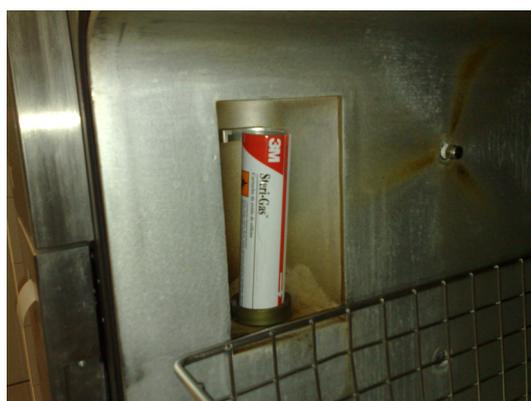
**Figura 4** – Cilindro de óxido de etileno numa câmara de esterilização a nível hospitalar
