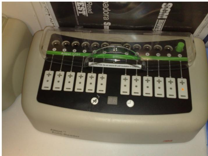
**Figura 10** – Estufa para incubação dos indicadores biológicos utilizados no processo de esterilização por óxido de etileno (Fonte: Catálogo da 3M)
