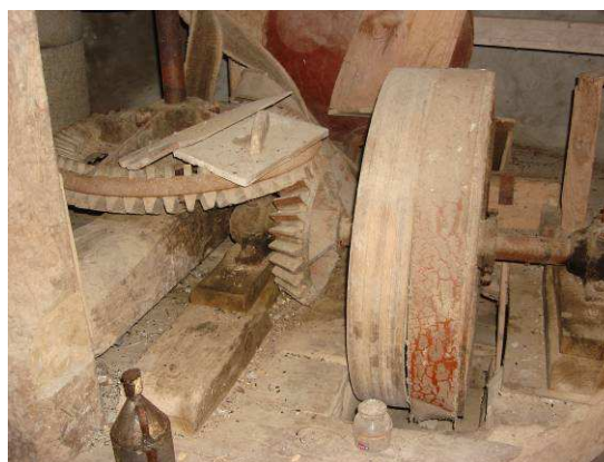
Ilustração 39 - Exemplo de sistema motor acoplado - moinho MV028.
