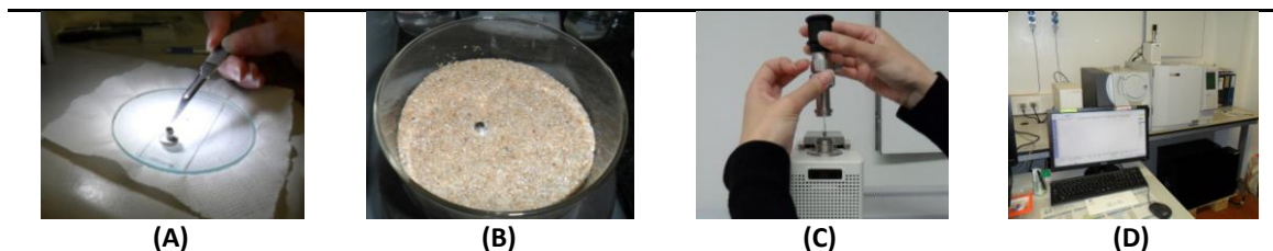
Figura 11A. Preparação da amostra: (A) Colocação da micro-amostra na cápsula; (B) após adição do agente derivatizante, secagem durante 15 min num banho de areia; (C) injeção da amostra; (D) equipamento Py-GC-MS.
