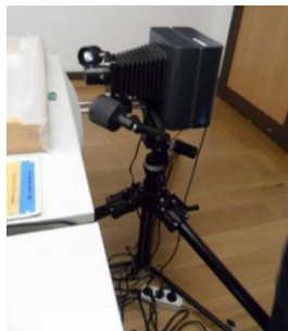
Figura 1A. Exemplo da montagem do equipamento de reflectografia do infravermelho.
