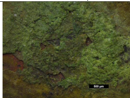
Zona de corrosão véu
