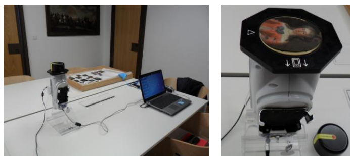
Figura 6A. Exemplo da análise de uma das miniaturas (ME15) por pXRF.
