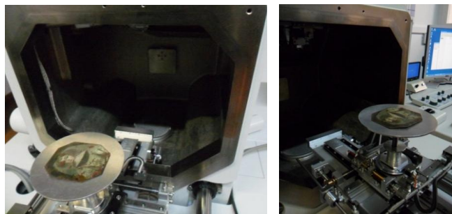
Figura 3A. Exemplo da análise de uma das miniaturas por SEM-EDS, sob duas perspectivas diferentes.
