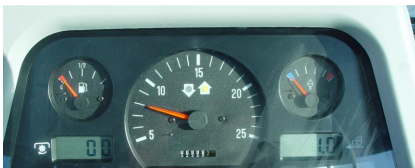
Conta-rotações (mostrador central) do tractor Massey Ferguson 5465. A leitura faz-se multiplicando por 100 o número indicado (neste caso 800rpm)
