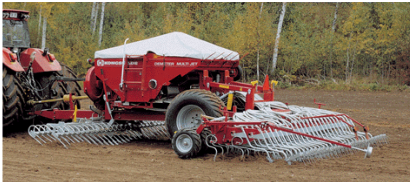
Semeador de fluxo contínuo com distribuição de semente em corrente de ar
