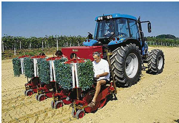
Plantador: exemplo de trabalho que requer velocidades super-lentas
