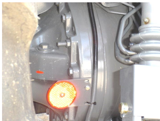
Caixa do redutor final traseiro, do lado esquerdo, do trator Fendt 415 Vario
