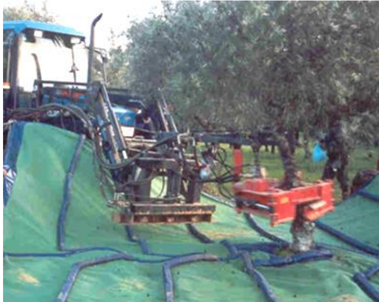
Colheita mecânica de azeitona com vibrador de tronco
