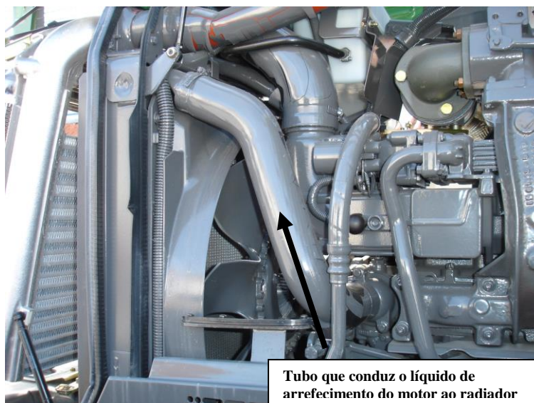
Tubo que conduz o líquido de arrefecimento do motor ao radiador Tractor Fendt 415 Vario – Tractores e Equipamentos Automotrizes 2011/2012
