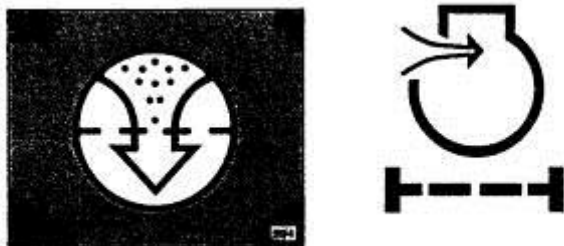
Exemplo de luzes indicadoras de colmatagem do filtro de ar
