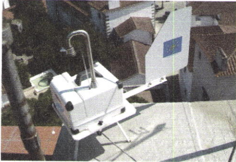
Figura 27 Visão do Coriolis ® instalado plataforma com sua aba de cata-vento
