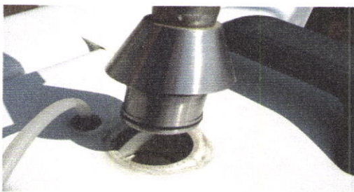
Figura 30 Nova conexão do tubo de sucção
