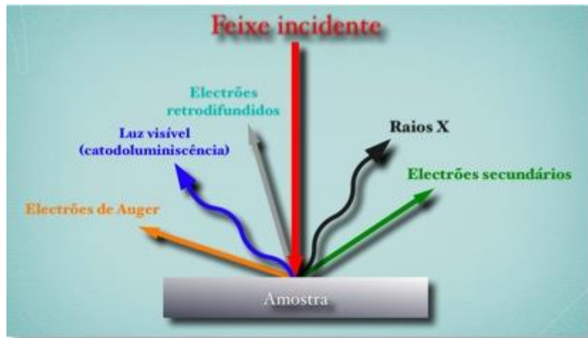
Figura 2.7. Interação feixe-amostra no SEM [63].
