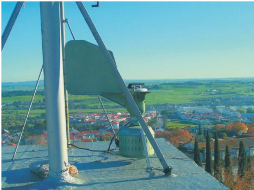
Figura 1.1: Método volumétrico de Hirst. Burkard Seven Day Volumetric Spore-trape ®.
