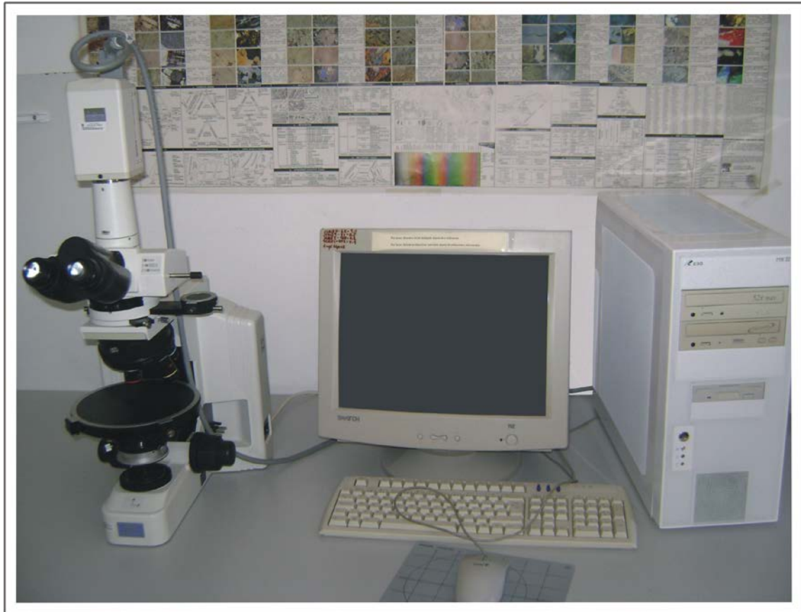
Figura 3.2- Microscópio petrográfico com câmara digital do Centro de Geofísica de Évora/Departamento de Geociências da Universidade de Évora.
