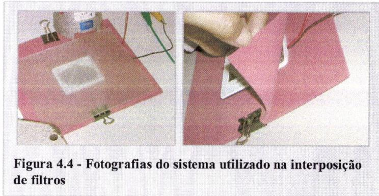
À esquerda na figura 4.4 colocámos um vidro fosco que cobria toda a célula. À direita, colocámos um filtro que cobria praticamente toda a célula e garantimos que toda a radiação que incidia sobre esta passasse pelo filtro. Para cada filtro e utilizando uma lâmpada de incandescência, fez-se variar a resistência de carga, medindo a d.d.p. e a intensidade da corrente para cada valor da resistência e os resultados obtidos encontram-se na figura 4.6.
