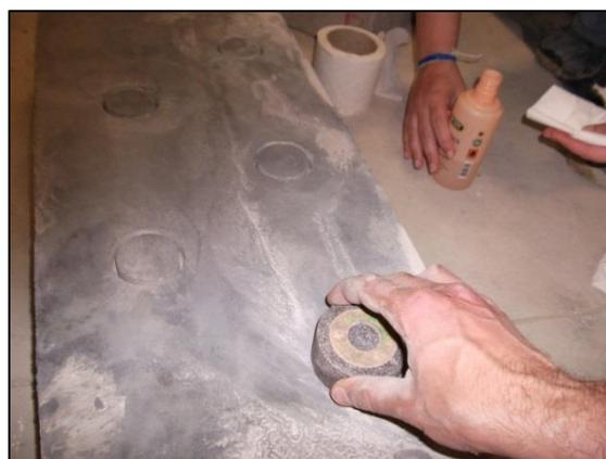
**Figura 51 - Preparação das zonas circulares para colagem das pastilhas metálicas**
