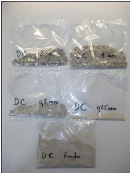
Figura 6 - Granulometria do endurecedor B1
