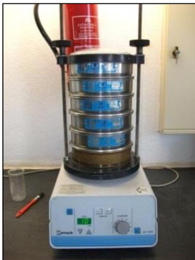
**Figura 5 - Coluna de peneiros disposta no agitador mecânico**
