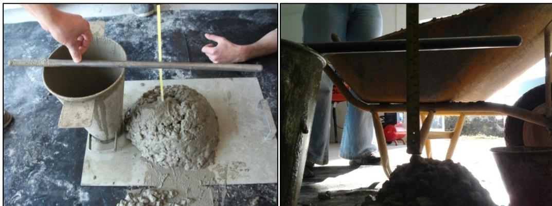
**Figura 18 - Medição do abaixamento obtido**
