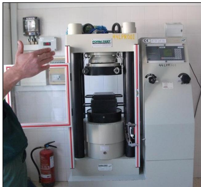
**Figura 28 - Máquina de resistência à compressão**
