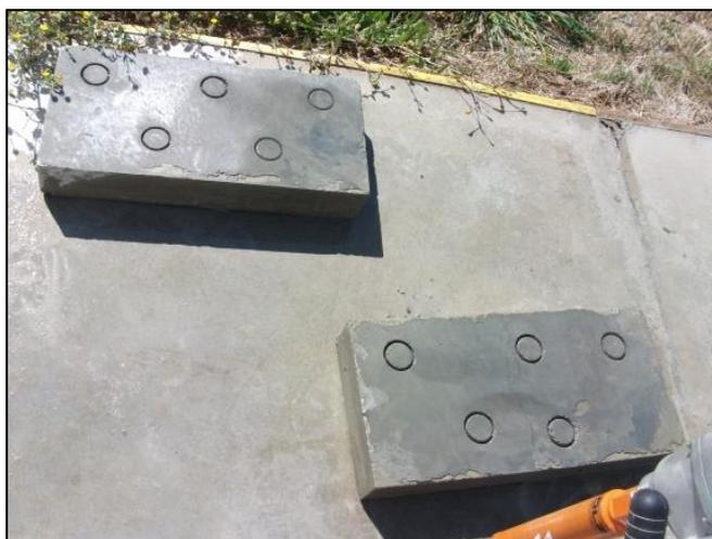
Figura 49 - Zonas a ensaiar previamente cortadas
