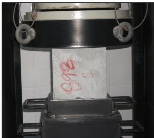
Figura 44 - Provete sendo comprimido durante o ensaio
