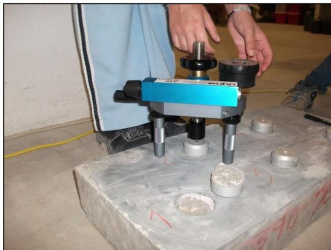
Figura 55 - Execução do ensaio de arrancamento por pull-off
