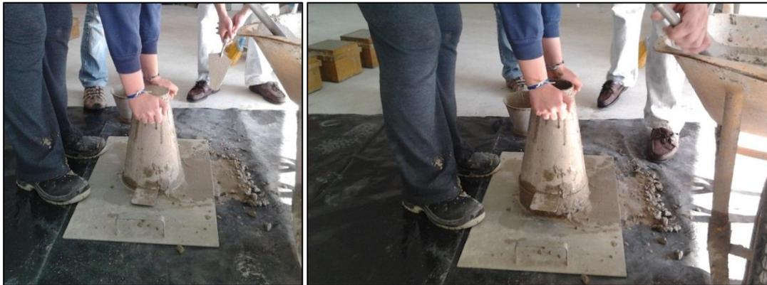
**Figura 17 - Remoção do molde**
