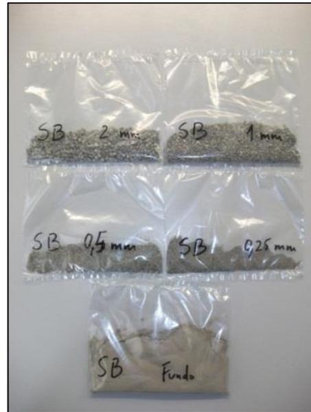
Figura 7 - Granulometria do endurecedor B2
