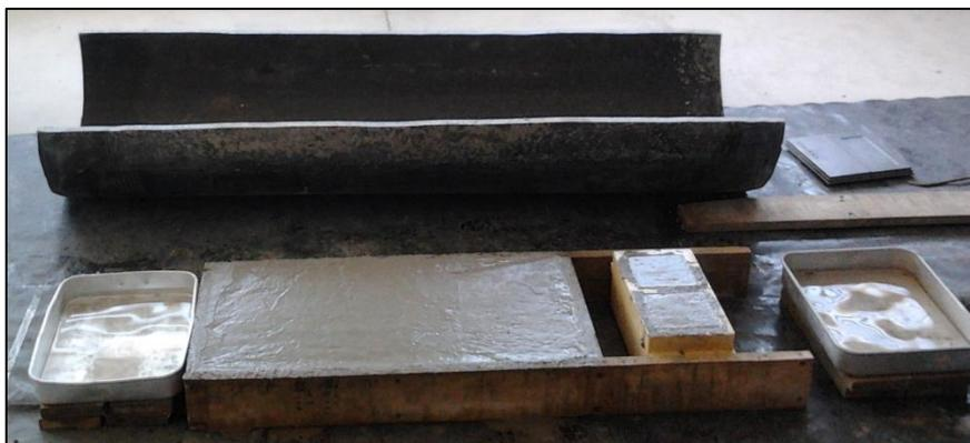
**Figura 32 - Forma de colocação da lajeta, dos cubos de 10 cm de aresta e dos tabuleiros com água**
