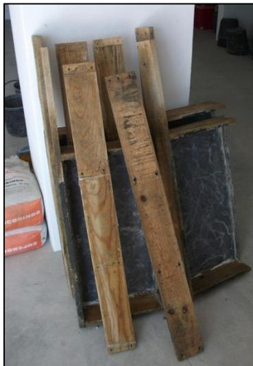
Figura 15 - Moldes para cofragem das lajetas
