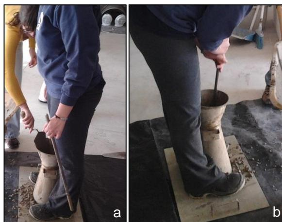
Figura 16 - Colocação (a) e compactação (b) da camada de fundo
