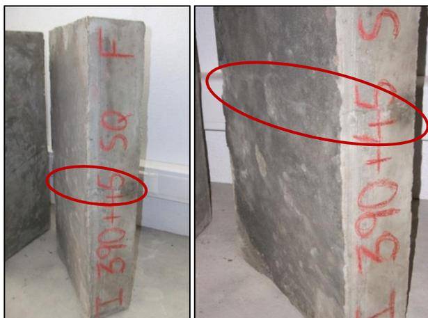
**Figura 66 - Fissura ocorrida a meio da lajeta**
