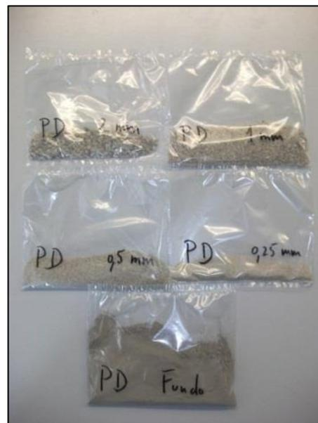
Figura 9 - Granulometria do endurecedor Q2
