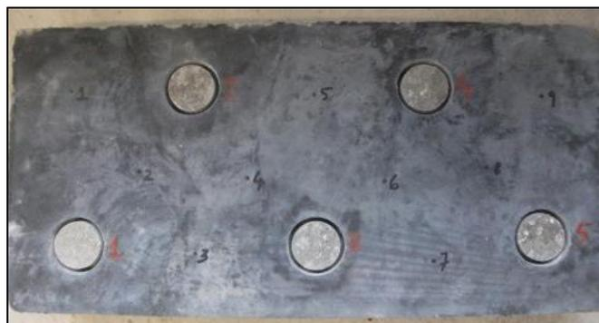
Figura 59 - Zonas ensaiadas numeradas
