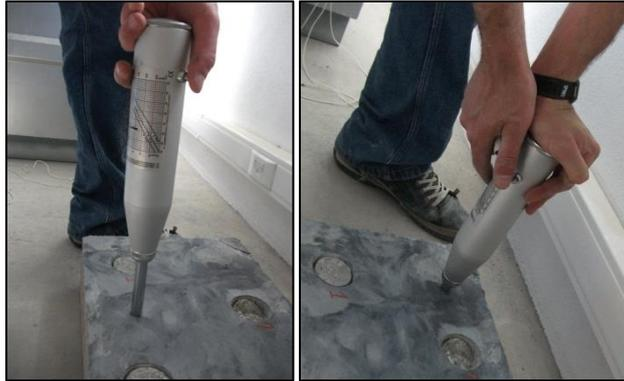
Figura 57 - Execução do ensaio para a determinação do índice esclerométrico
