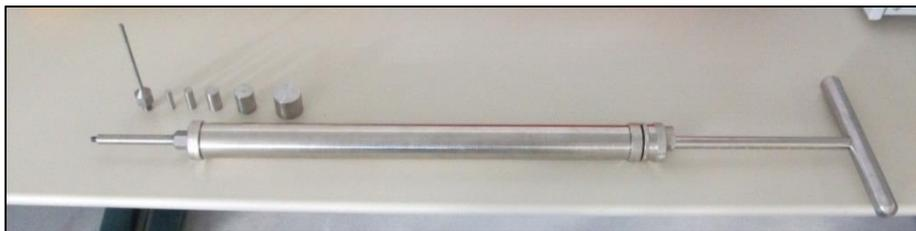
**Figura 21 - Aparelho para penetração e respectiva série de agulhas**
