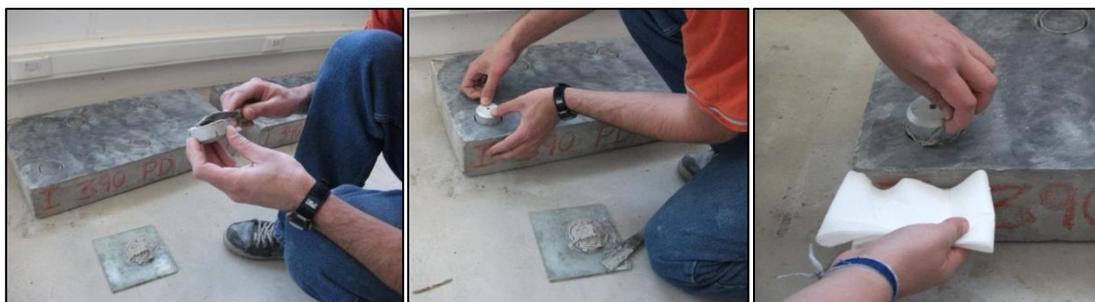
Figura 53 - Processo de colagem das pastilhas metálicas
