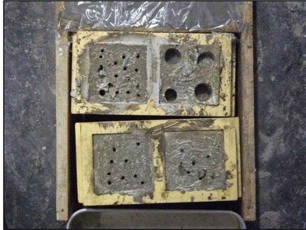
**Figura 23 - Provetes evidenciando as diferentes secções das agulhas após a realização dos ensaios de penetração**
