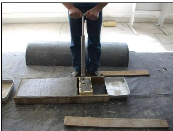
**Figura 22 - Realização de ensaio de penetração**
