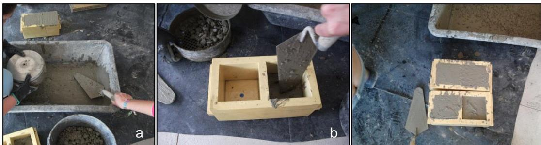
Figura 20 - Peneiração do betão (a) e colocação da argamassa (b) obtida nos moldes de 10 cm de aresta
