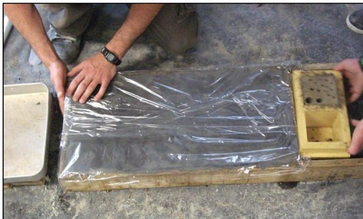
**Figura 43 - Cobertura da lajeta com película aderente**
