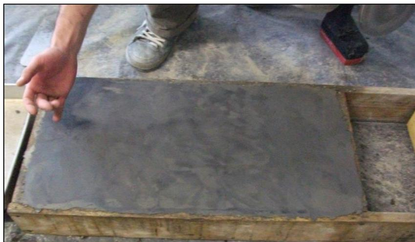
**Figura 68 - Verificação da densificação e regularidade numa das lajetas**
