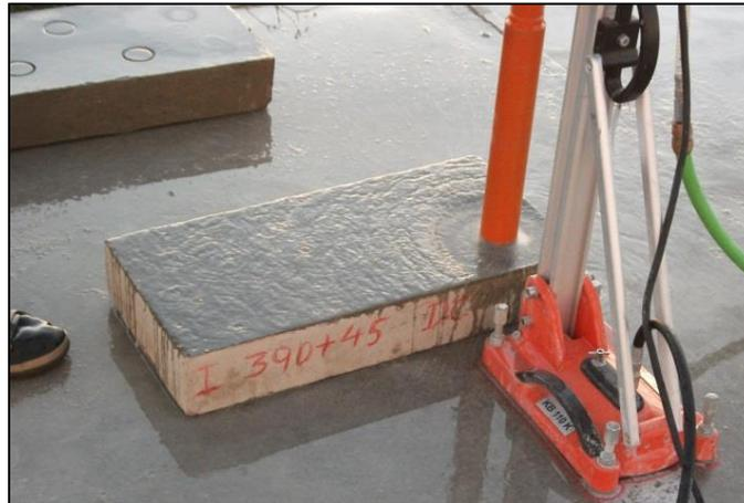
**Figura 50 - Zona a ensaiar sendo cortada com auxílio de caroteadora**
