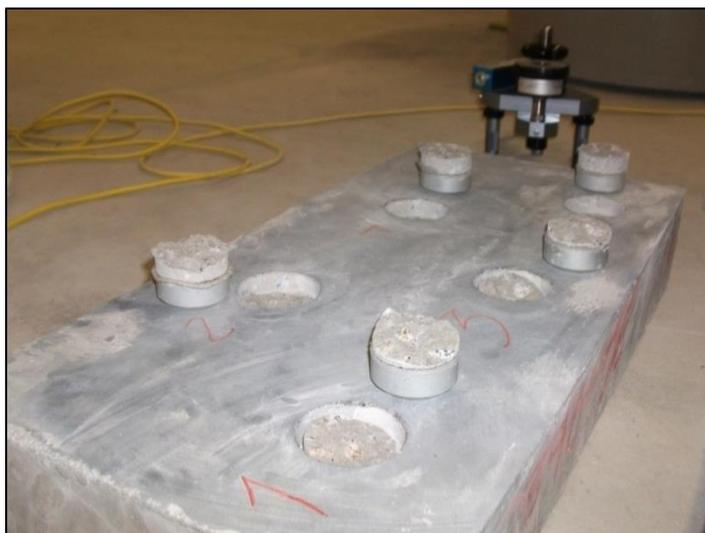
**Figura 56 - Resultados obtidos com o arrancamento por pull-off**
