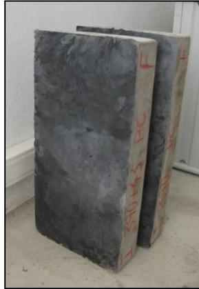
**Figura 69 - Aspecto final da superfície da lajeta P+45\_C**
