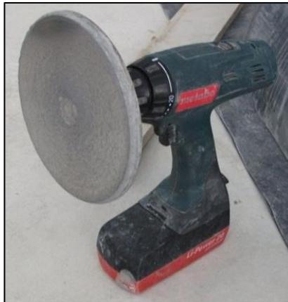
**Figura 38 - Afagador utilizado no processo de afagamento das lajetas**
