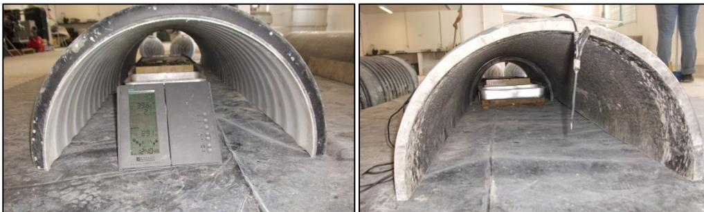
**Figura 31 - Termómetros para registo de temperaturas em cada túnel**
