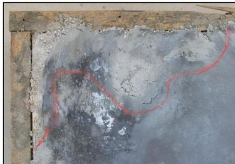
**Figura 65 - Destacamento de endurecedor do betão de base num dos cantos da lajeta P+45\_B2**
