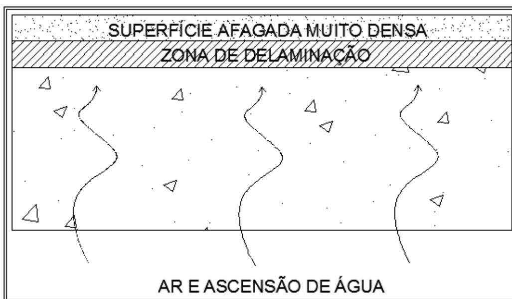
Figura 1 - Esquema representativo da zona de delaminação (National Ready Mixed Concrete Association, 2004)
