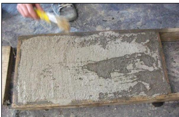
**Figura 37 - Salpico de água sobre o endurecedor de superfície na lajeta**
