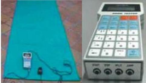
**Figura 7** - Plataforma de saltos Ergojump Digitime 1000, Digitest Finland
