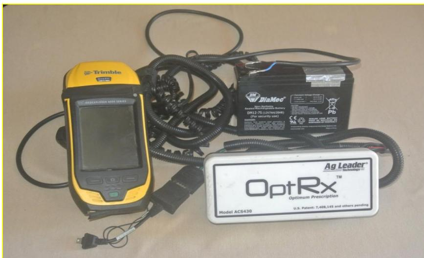
Figura 8. Sensor óptico (“OptRx<sup>®</sup>”), receptor GPS (“Trimble”) e bateria portátil, utilizados nos ensaios de campo.
