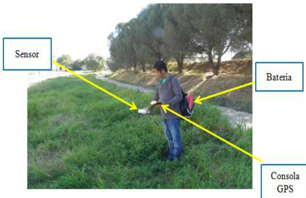
Figura 11. Operador durante a recolha de dados com o sensor óptico “OptRx<sup>®</sup>”.
