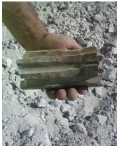
Figura 5.7 – Bit de botões retratil de 76 mm de diâmetro.
