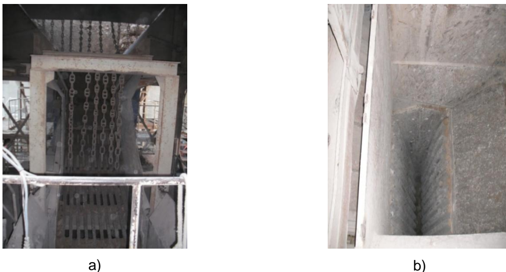
Figura 5.14 – Início da linha de britagem a) Torva e crivo; b) Britador de Maxilas.
