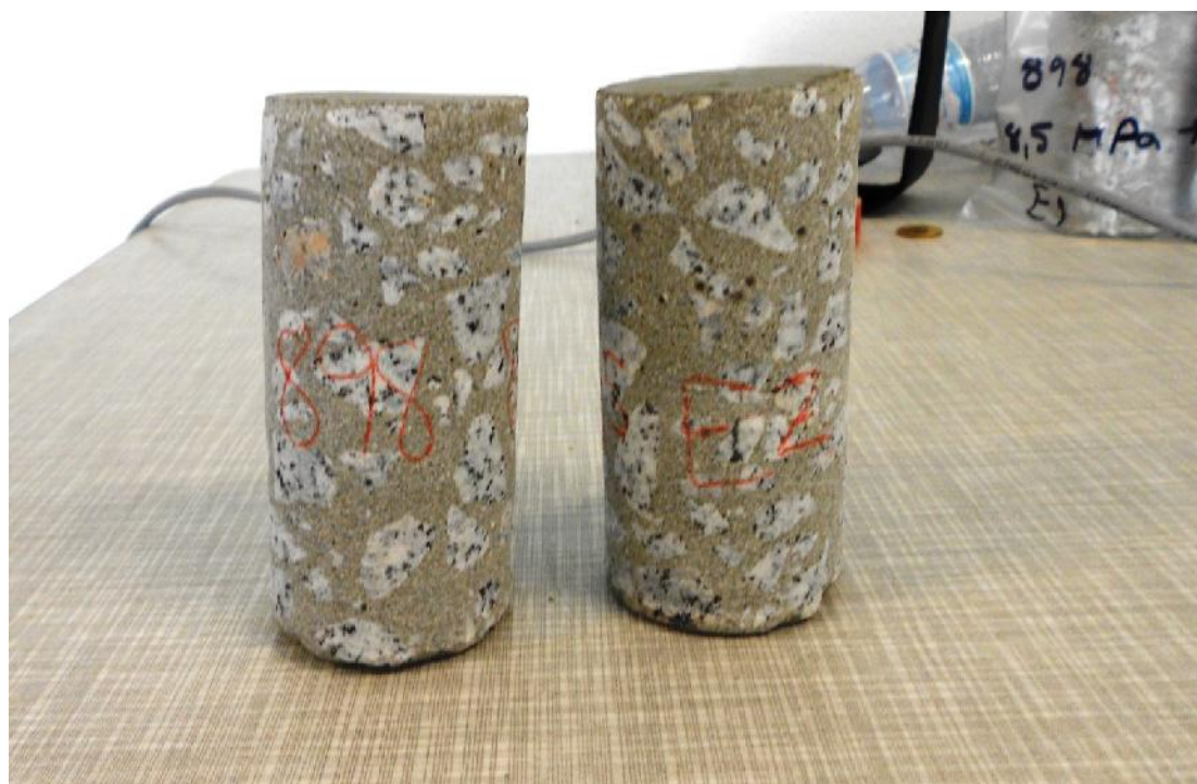
Figura 4.39 – Carotes retiradas da lajeta C2E2 aos 8,5 MPa de aplicação do endurecedor
