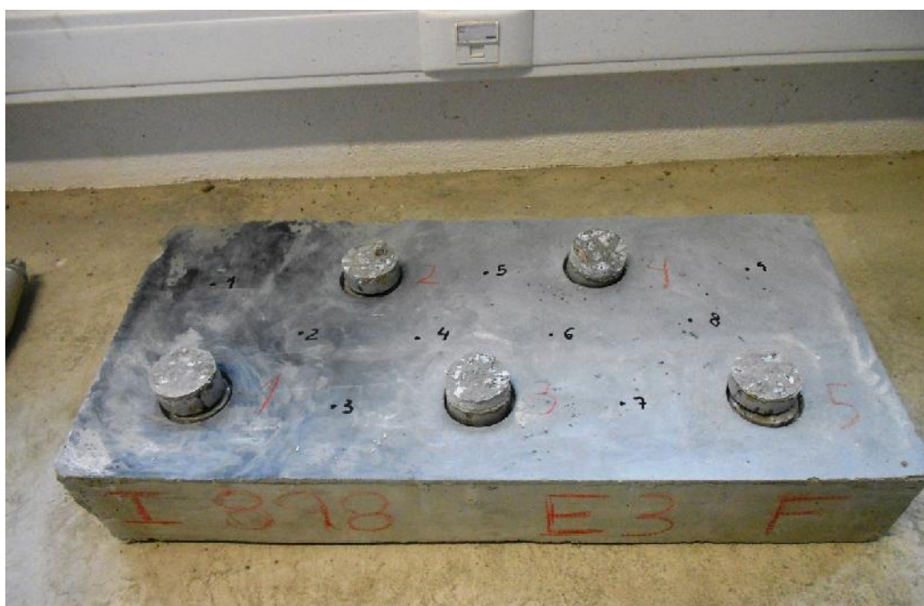
Figura 4.17 – Ruturas apresentadas pela lajeta C2E3 aos 8,5 MPa de resistência à penetração
