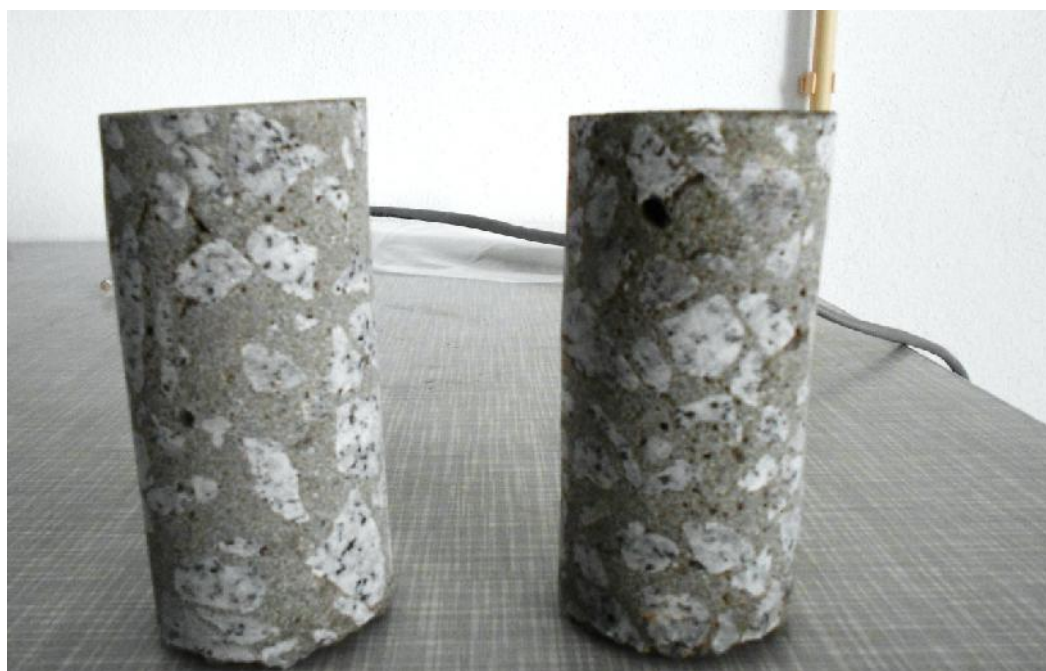
Figura 4.35 – Carotes retiradas da lajeta C1E6 aos 8,5 MPa de aplicação do endurecedor
