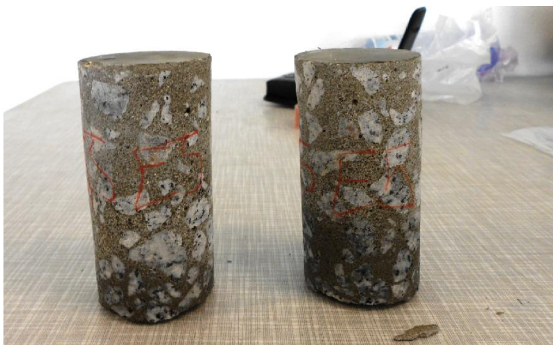
Figura 4.45 – Carotes retiradas da lajeta C2E5 aos 8,5 MPa de aplicação do endurecedor
