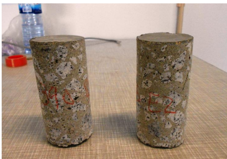
Figura 4.27 – Carotes retiradas da lajeta C1E2 aos 8,5 MPa de aplicação do endurecedor
