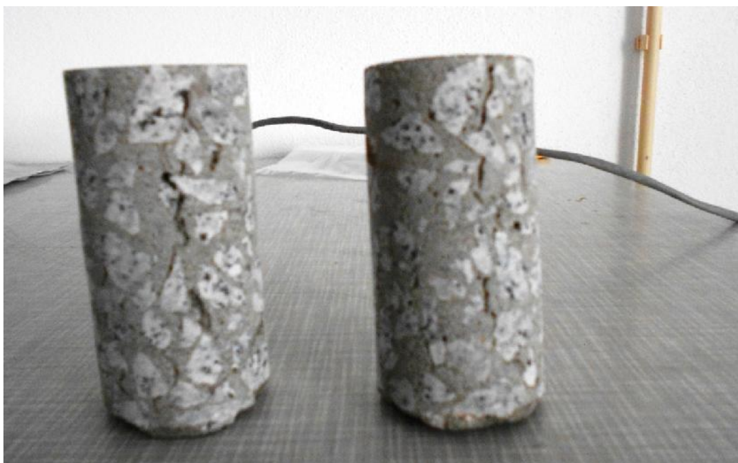
Figura 4.36 – Carotes retiradas da lajeta C1E6 aos 8,5 MPa mais 45 min de aplicação do endurecedor
