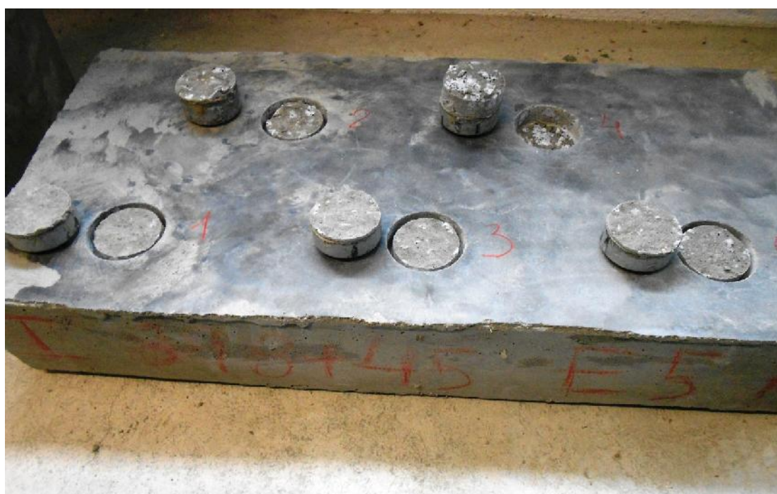
Figura 4.22 – Ruturas apresentadas pela lajeta C2E5 aos 8,5 MPa+45 min de resistência à penetração
