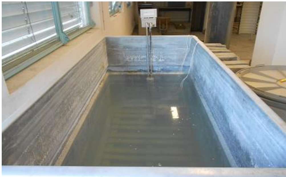
Figura 3.21 – Tanque de cura
