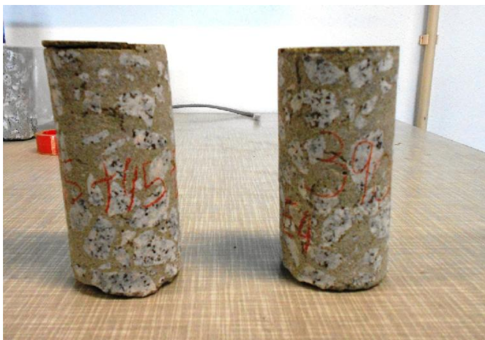
Figura 4.32 – Carotes retiradas da lajeta C1E4 aos 8,5 MPa mais 45 min de aplicação do endurecedor
