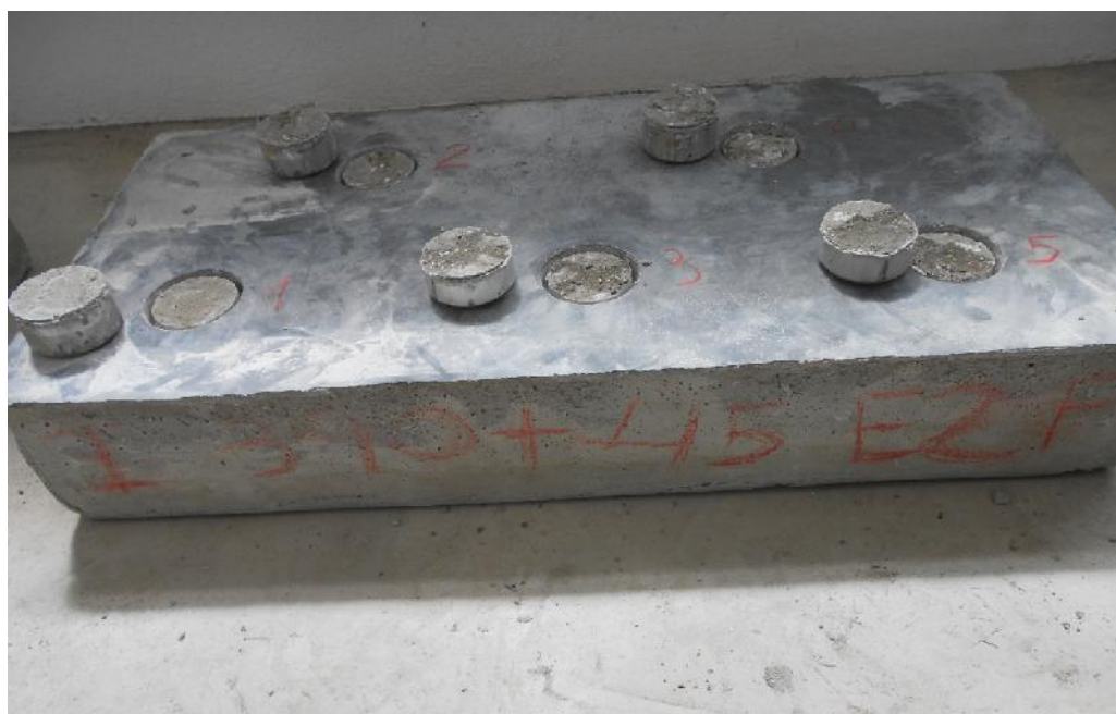
Figura 4.4 – Ruturas apresentadas pela lajeta C1E2 aos 8,5 MPa+45 min de resistência à penetração
