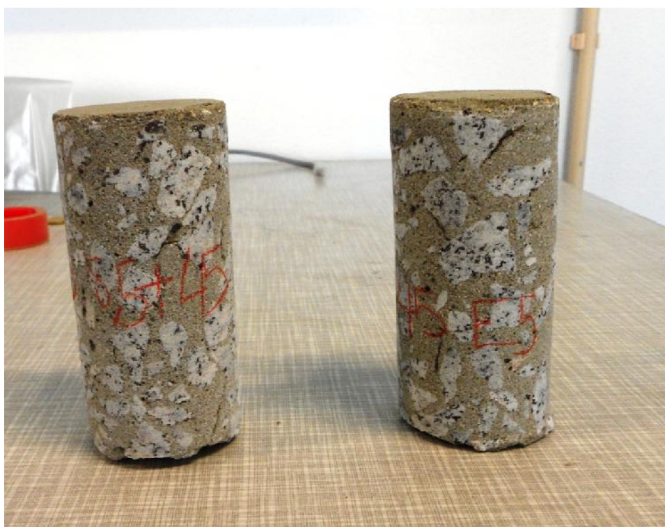
Figura 4.34 – Carotes retiradas da lajeta C1E5 aos 8,5 MPa mais 45 min de aplicação do endurecedor
