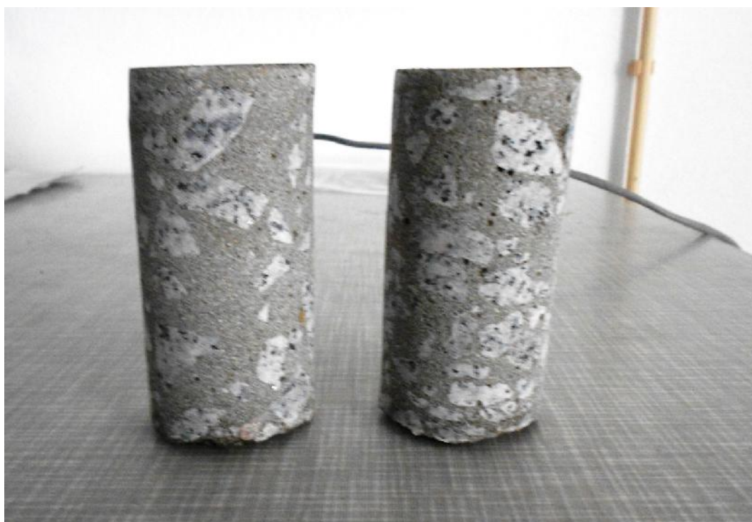
Figura 4.48 – Carotes retiradas da lajeta C2E6 aos 8,5 MPa mais 45 min de aplicação do endurecedor
