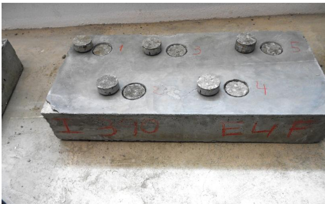
Figura 4.7 – Ruturas apresentadas pela lajeta C1E4 aos 8,5 MPa de resistência à penetração
