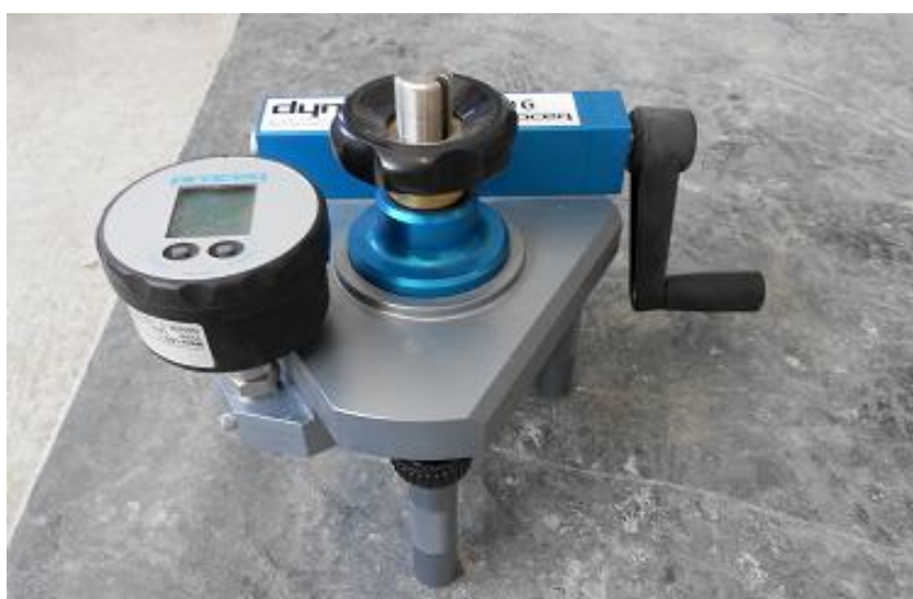
Figura 3.25 – Equipamento de ensaio de pull-off
