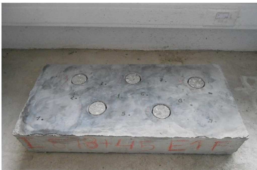
Figura 4.14 – Ruturas apresentadas pela lajeta C2E1 aos 8,5 MPa+45 min de resistência à penetração
