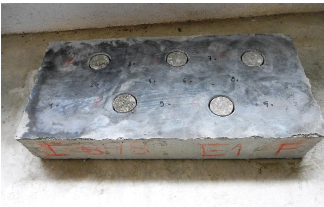
Figura 4.13 – Ruturas apresentadas pela lajeta C2E1 aos 8,5 MPa de resistência à penetração
