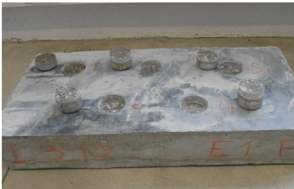
Figura 4.1 – Ruturas apresentadas pela lajeta C1E1 aos 8,5 MPa de resistência à penetração
