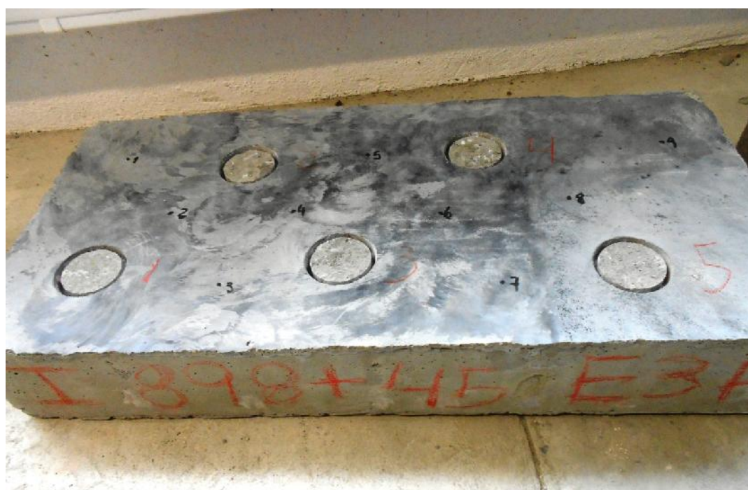
Figura 4.18 – Ruturas apresentadas pela lajeta C2E3 aos 8,5 MPa+45 min de resistência à penetração
