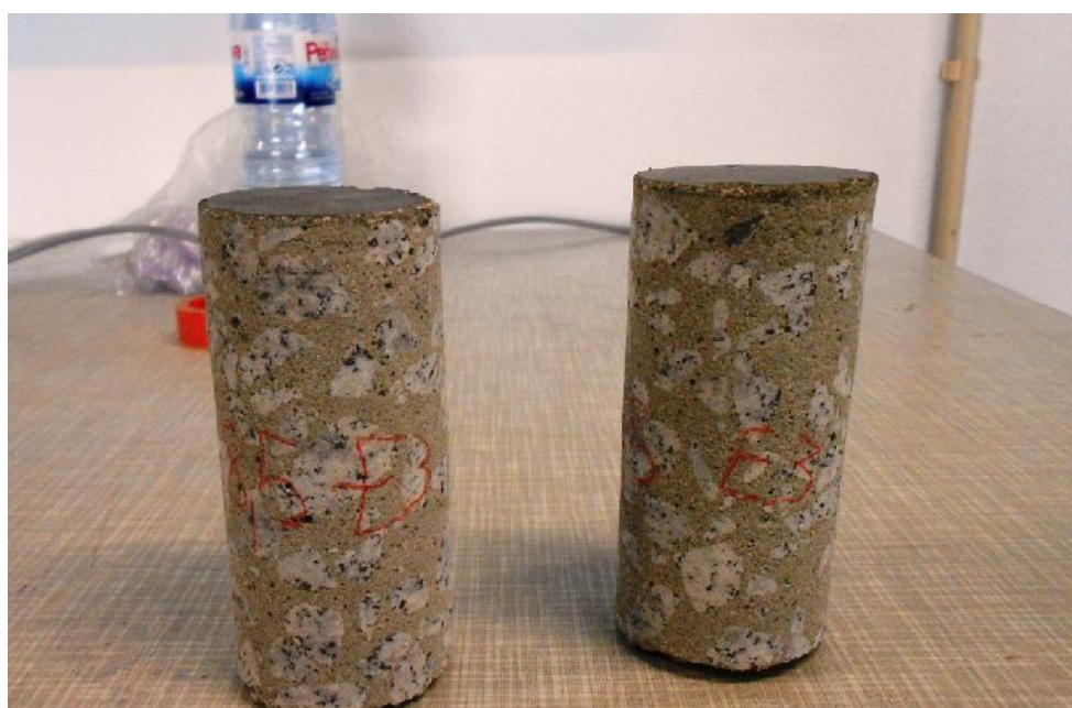
Figura 4.29 – Carotes retiradas da lajeta C1E3 aos 8,5 MPa de aplicação do endurecedor
