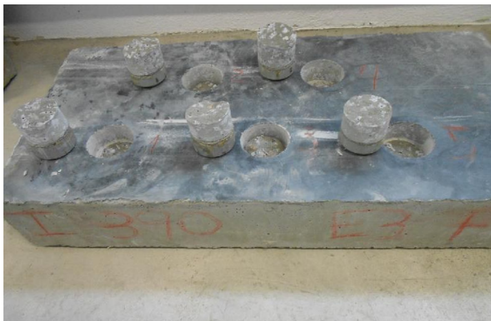
Figura 4.5 – Ruturas apresentadas pela lajeta C1E3 aos 8,5 MPa de resistência à penetração
