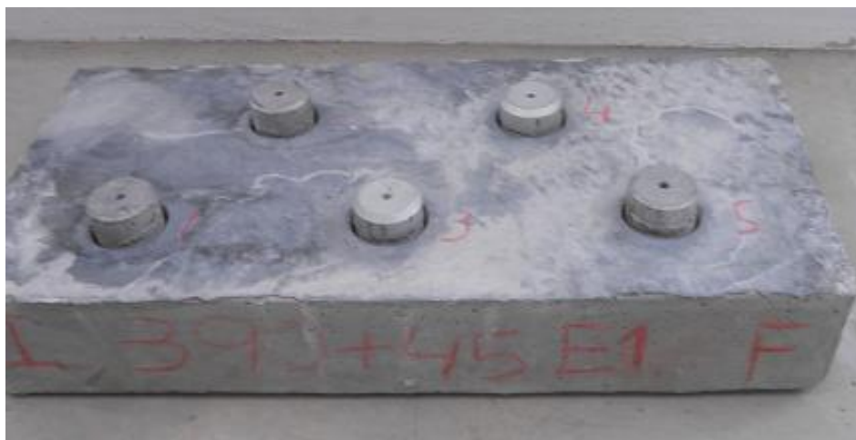
Figura 3.24 – Colagem das pastilhas
