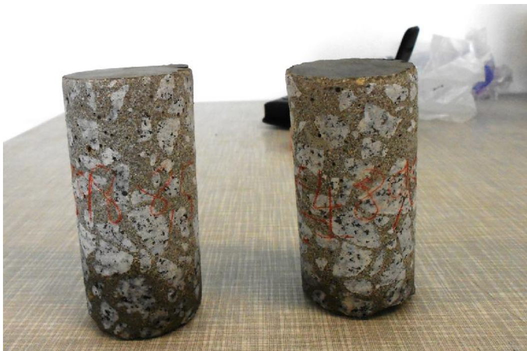
Figura 4.44 – Carotes retiradas da lajeta C2E4 aos 8,5 MPa mais 45 min de aplicação do endurecedor
