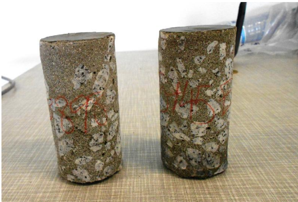
Figura 4.42 – Carotes retiradas da lajeta C2E3 aos 8,5 MPa mais 45 min de aplicação do endurecedor
