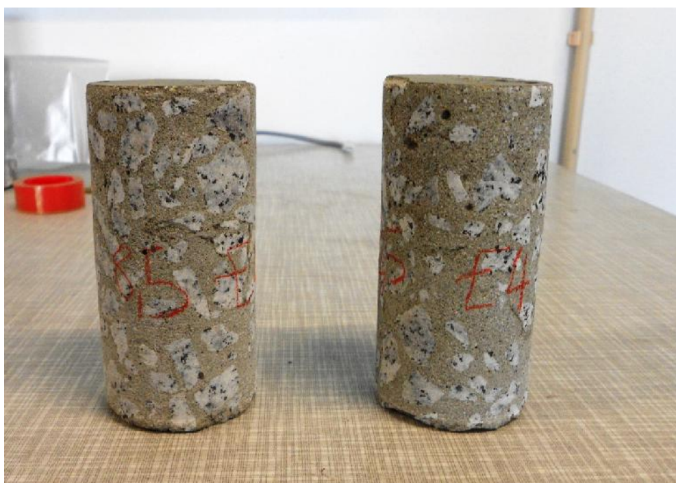
Figura 4.31 – Carotes retiradas da lajeta C1E4 aos 8,5 MPa de aplicação do endurecedor
