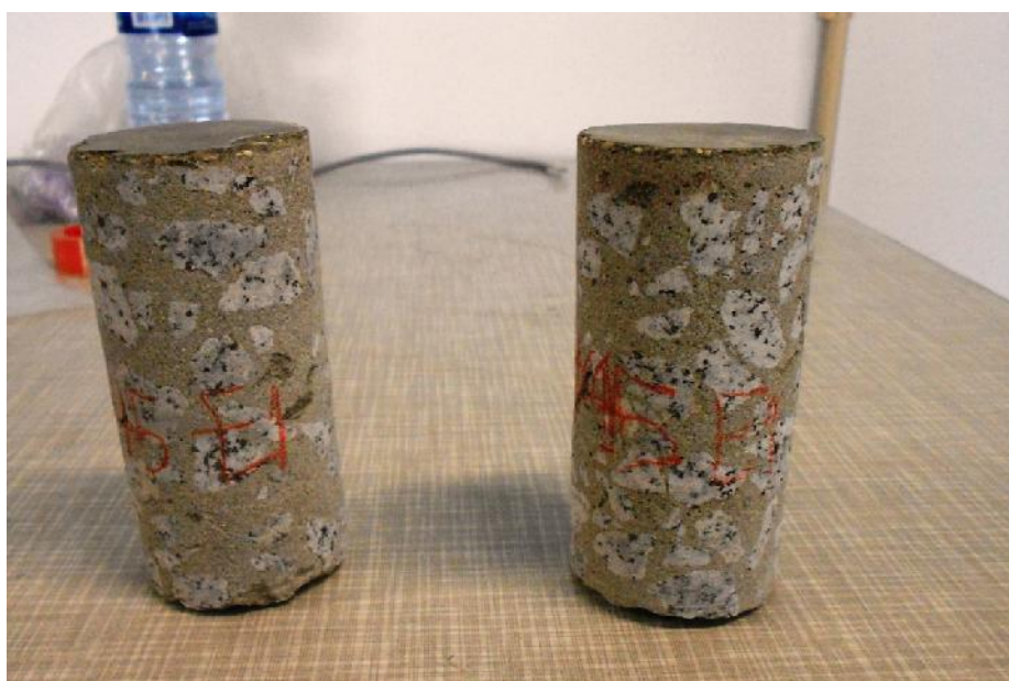
Figura 4.26 – Carotes retiradas da lajeta C1E1 aos 8,5 MPa mais 45 min de aplicação do endurecedor
