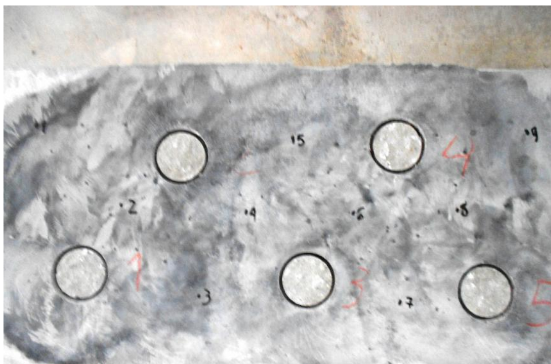
Figura 4.24 – Ruturas apresentadas pela lajeta C2E6 aos 8,5 MPa+45 min de resistência à penetração
