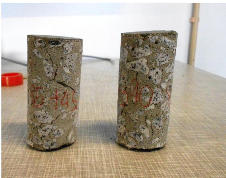
Figura 4.30 – Carotes retiradas da lajeta C1E3 aos 8,5 MPa mais 45 min de aplicação do endurecedor
