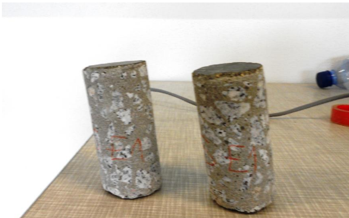
Figura 4.37 – Carotes retiradas da lajeta C2E1 aos 8,5 MPa de aplicação do endurecedor
