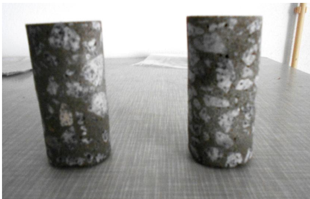
Figura 4.47 – Carotes retiradas da lajeta C2E6 aos 8,5 MPa de aplicação do endurecedor
