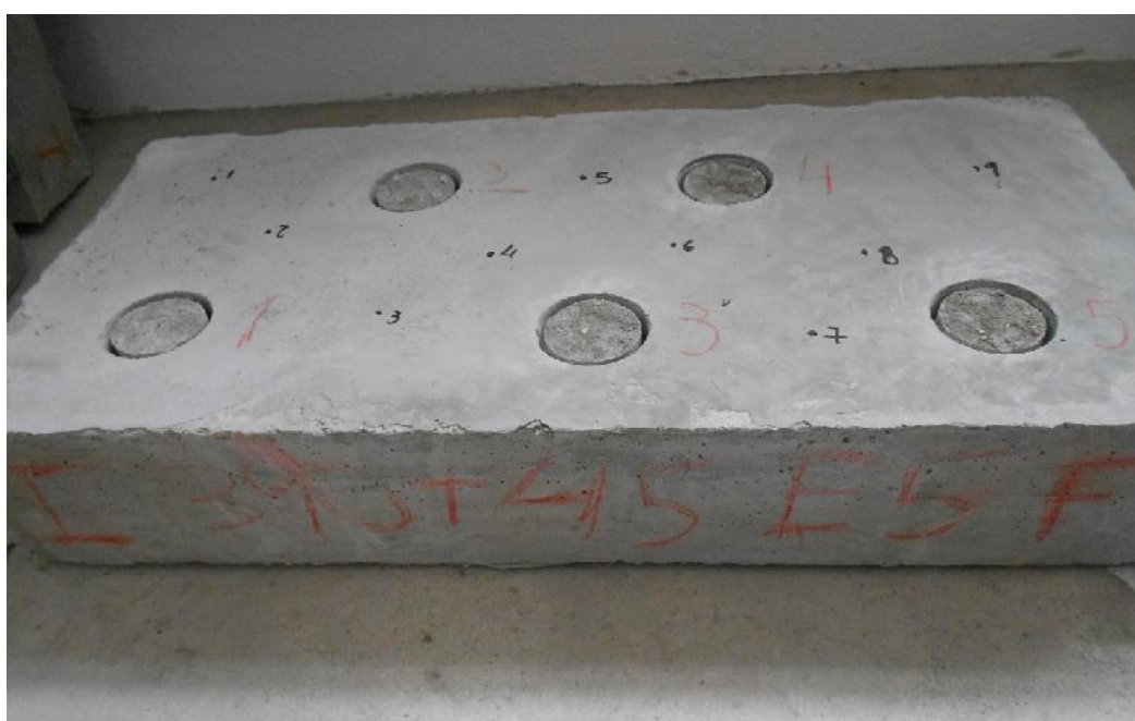
Figura 4.10 – Ruturas apresentadas pela lajeta C1E5 aos 8,5 MPa+45 min de resistência à penetração
