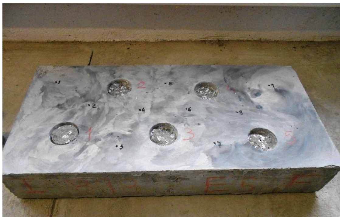
Figura 4.21 – Ruturas apresentadas pela lajeta C2E5 aos 8,5 MPa de resistência à penetração
