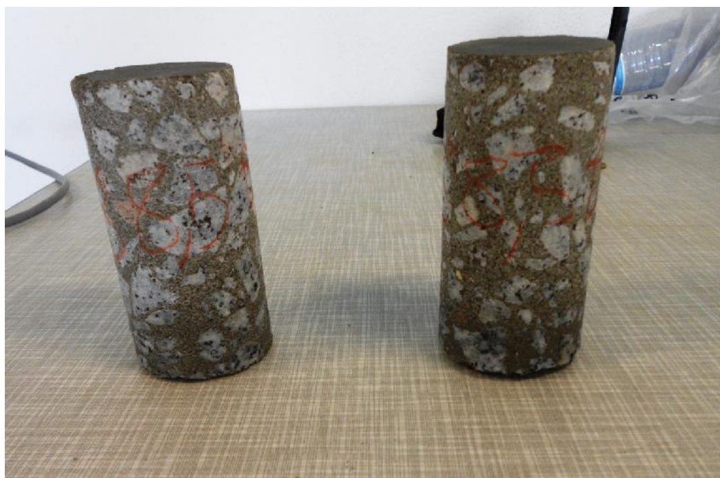
Figura 4.41 – Carotes retiradas da lajeta C2E3 aos 8,5 MPa de aplicação do endurecedor
