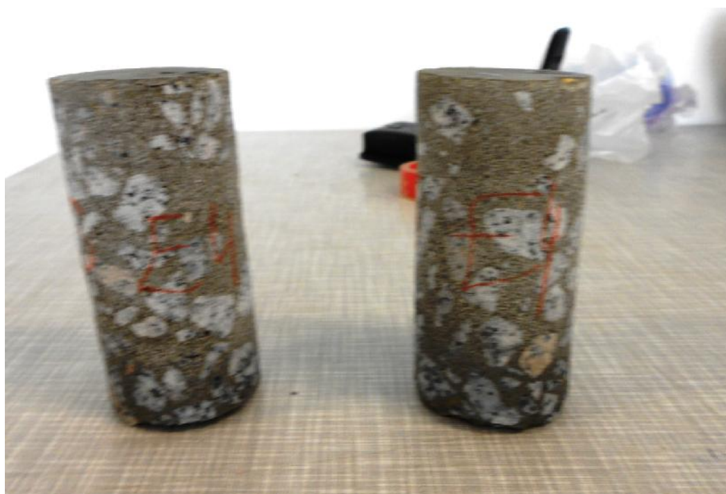
Figura 4.43 – Carotes retiradas da lajeta C2E4 aos 8,5 MPa de aplicação do endurecedor
