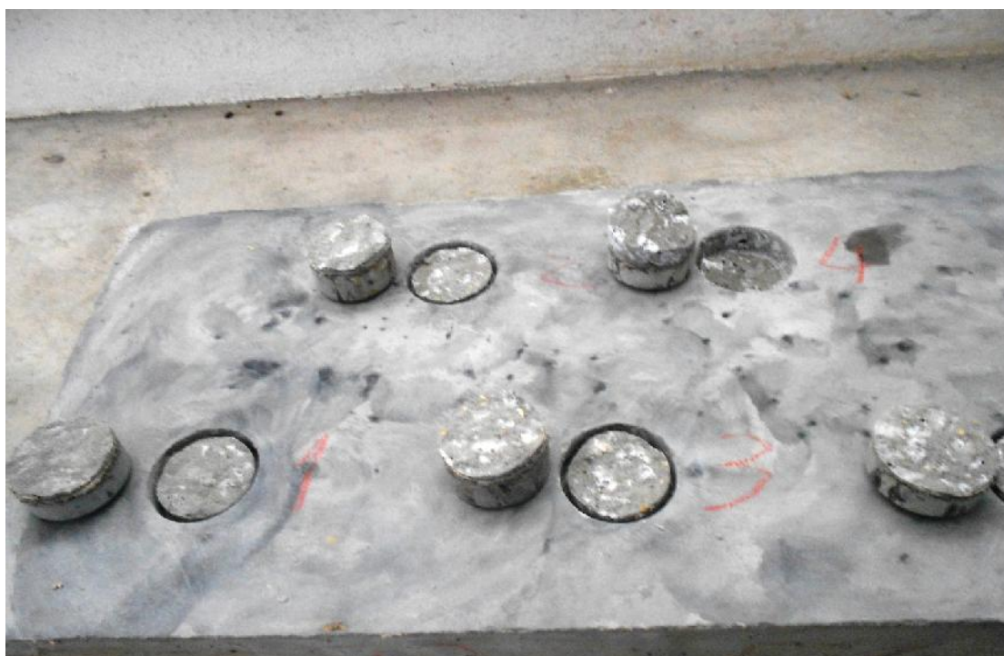
Figura 4.23 – Ruturas apresentadas pela lajeta C2E6 aos 8,5 MPa de resistência à penetração
