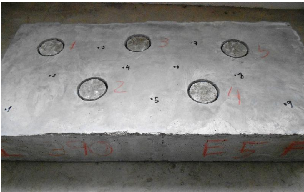
Figura 4.9 – Ruturas apresentadas pela lajeta C1E5 aos 8,5 MPa de resistência à penetração
