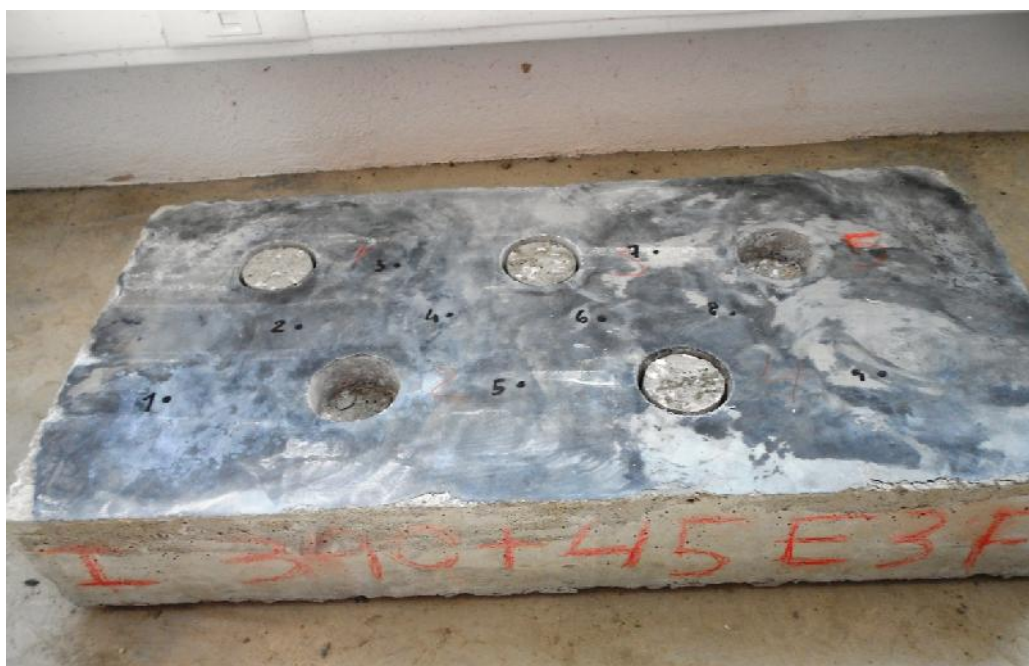
Figura 4.6 – Ruturas apresentadas pela lajeta C1 E3 aos 8,5 MPa+45 min de resistência à penetração
