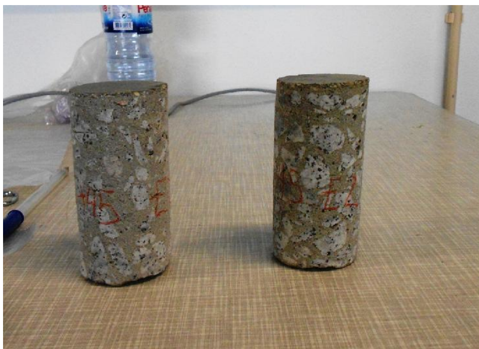
Figura 4.28 – Carotes retiradas da lajeta C1E2 aos 8,5 MPa mais 45 min de aplicação do endurecedor
