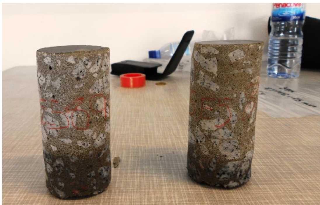
Figura 4.46 – Carotes retiradas da lajeta C2E5 aos 8,5 MPa mais 45 min de aplicação do endurecedor
