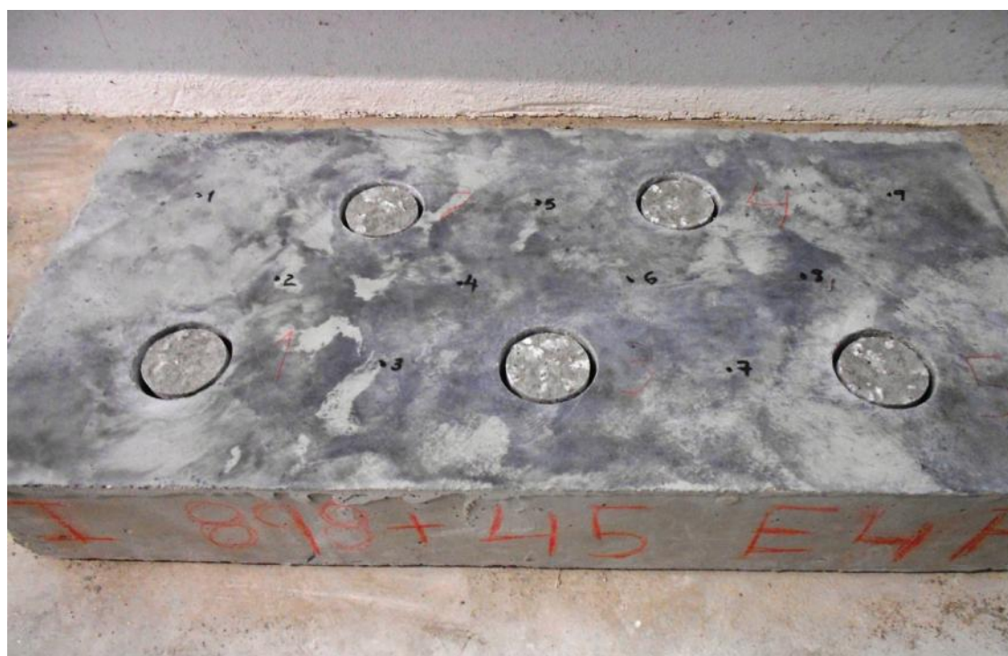
Figura 4.20 – Ruturas apresentadas pela lajeta C2E4 aos 8,5 MPa+45 min de resistência à penetração
