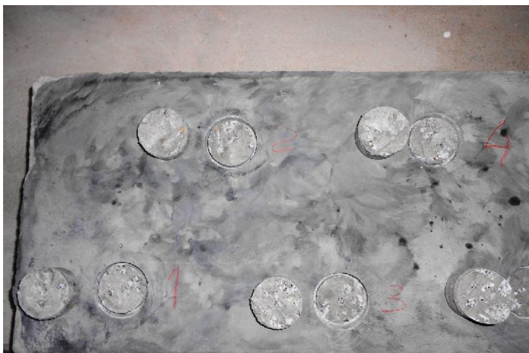
Figura 4.12 – Ruturas apresentadas pela lajeta C1E6 aos 8,5 MPa+45 min de resistência à penetração
