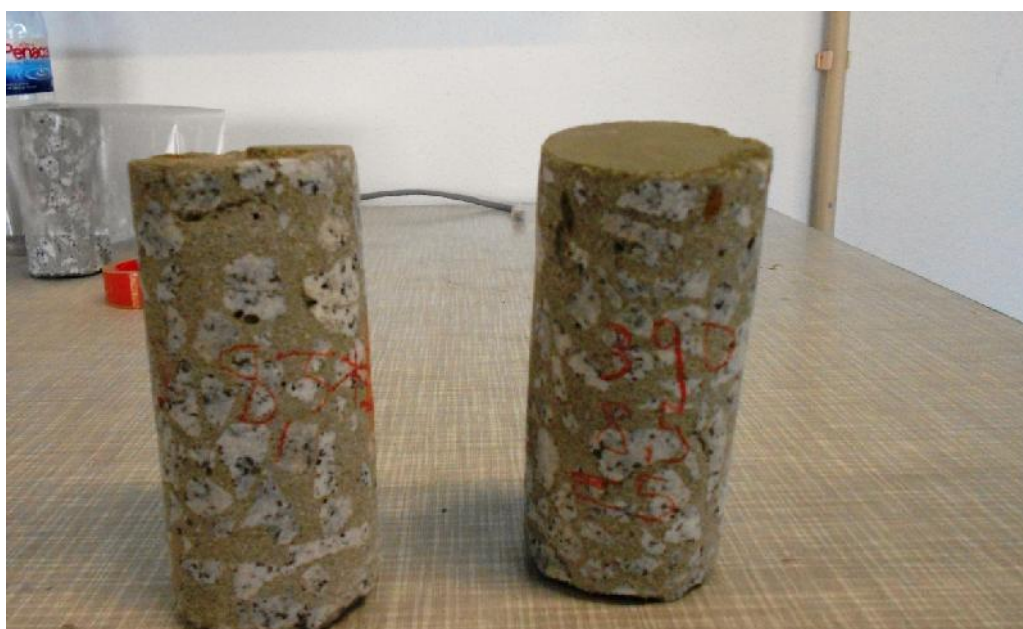
Figura 4.33 – Carotes retiradas da lajeta C1E5 aos 8,5 MPa de aplicação do endurecedor
