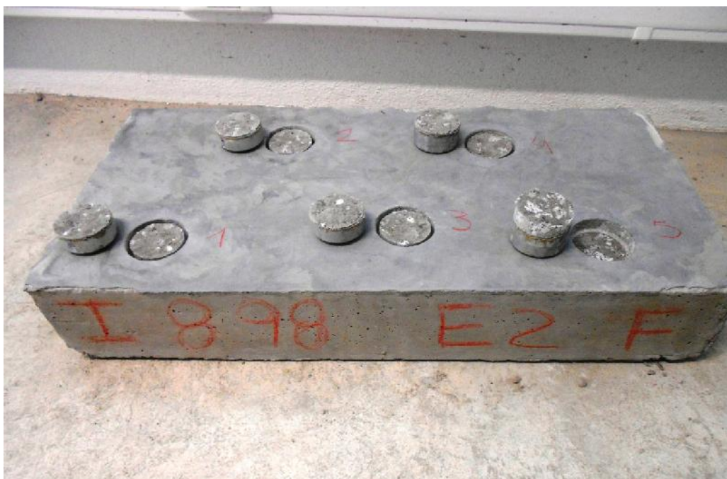
Figura 4.15 – Ruturas apresentadas pela lajeta C2E2 aos 8,5 MPa de resistência à penetração
