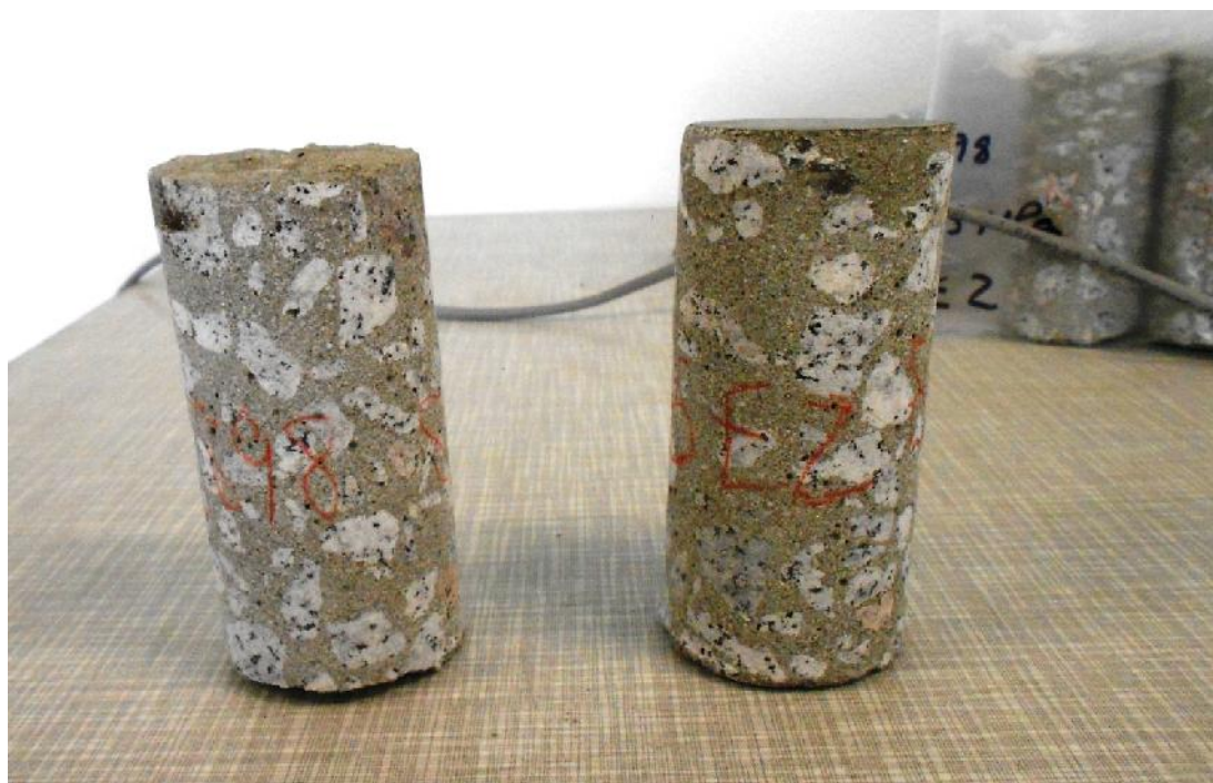
Figura 4.40 – Carotes retiradas da lajeta C2E2 aos 8,5 MPa mais 45 min de aplicação do endurecedor
