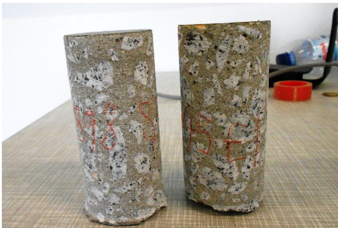
Figura 4.38 – Carotes retiradas da lajeta C2E1 aos 8,5 MPa mais 45 min de aplicação do endurecedor
