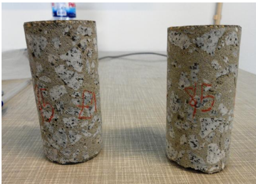
Figura 4.25 – Carotes retiradas da lajeta C1E1 aos 8,5 MPa de aplicação do endurecedor
