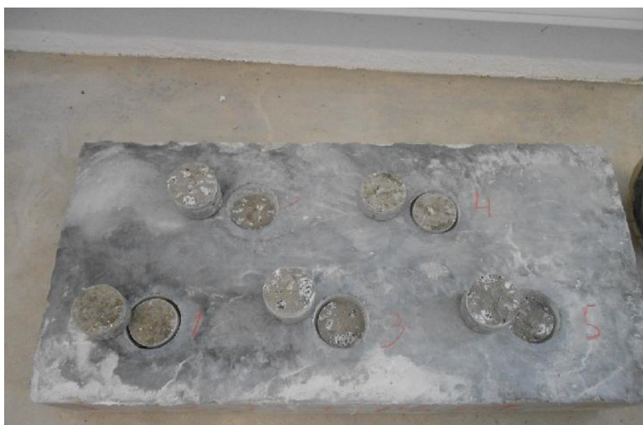
Figura 4.2 – Ruturas apresentadas pela lajeta C1E1 aos 8,5 MPa+45 min de resistência à penetração
