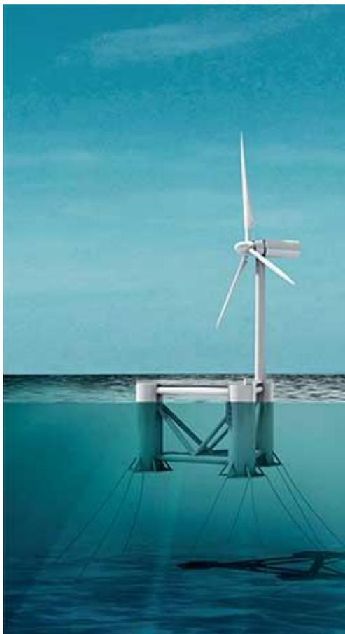
Figura 2.3 – Configuração da turbina eólica mais comum.
