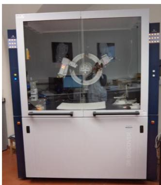
**Figura 2.7.** Difratômetro de raios-X
