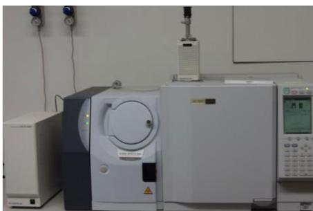
**Figura 2.8.** Equipamento de cromatografia gasosa acoplado a um espectrômetro de massa.
