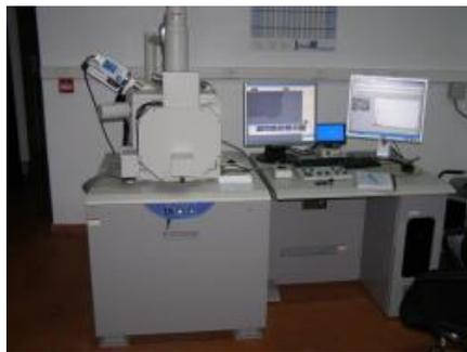
**Figura 2.2.** Microscópio eletrônico de varrimento com detetor de EDS
