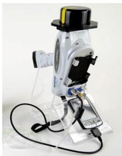
**Figura 2.6.** Espectrofotômetro portátil de fluorescência de raios-X
