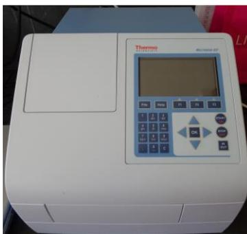
**Figura 2.5.** Leitor de microplacas
