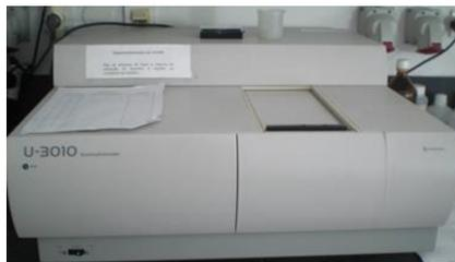
**Figura 2.4.** Espectrofotômetro de absorção molecular no UV/VIS
