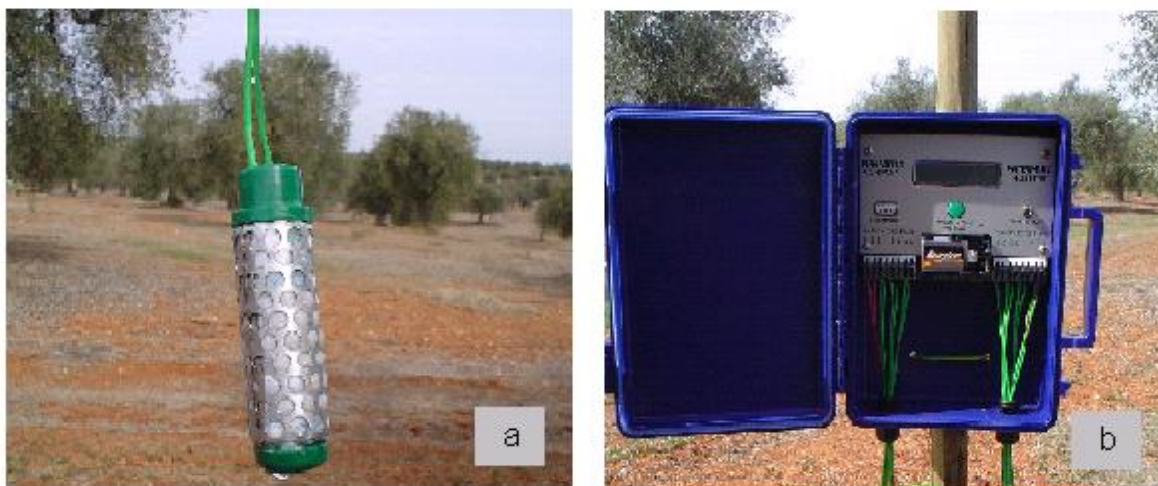
Figura 2.5 - Avaliação da humidade do solo. a. sensor Watermark; b. datalogger para recolha periódica da informação proveniente dos watermarks.
