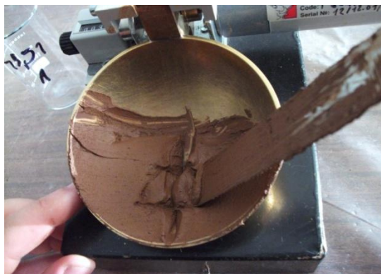
Fig. 8.18 - Remoção de fração da amostra, na zona da concha onde se deu a união.
