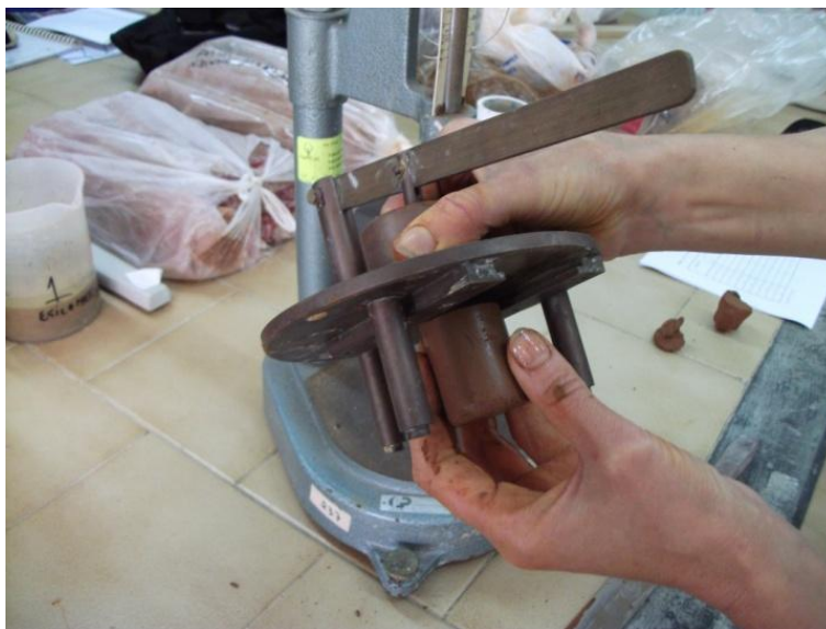
Fig. 8.37 - Execução de um provete com auxílio do molde próprio.
