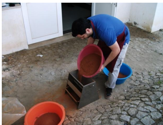
Fig. 8.9 - Partição da amostra inicial com o auxílio de um repartidor.
