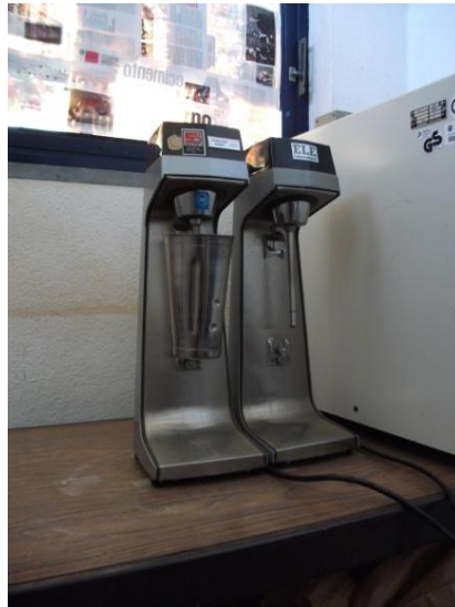
Fig. 8.14 - Agitadores mecânicos, da marca Soilstate e modelo Hamilton Beach.
