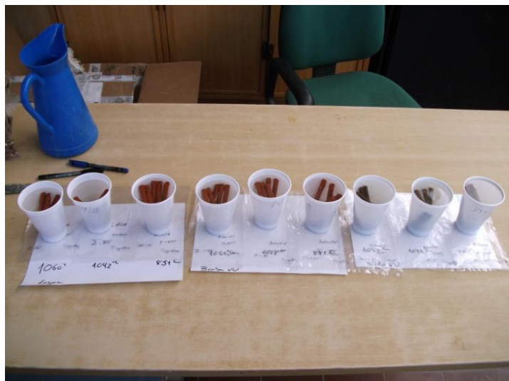
Fig. 8.31 - Provetes submersos em água na execução do ensaio de Absorção.
