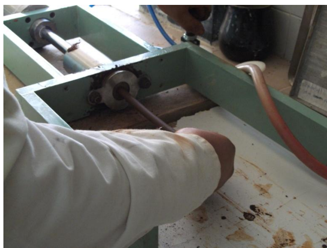
Fig. 8.26 – Extrusora Macocer e lastra de argila.
