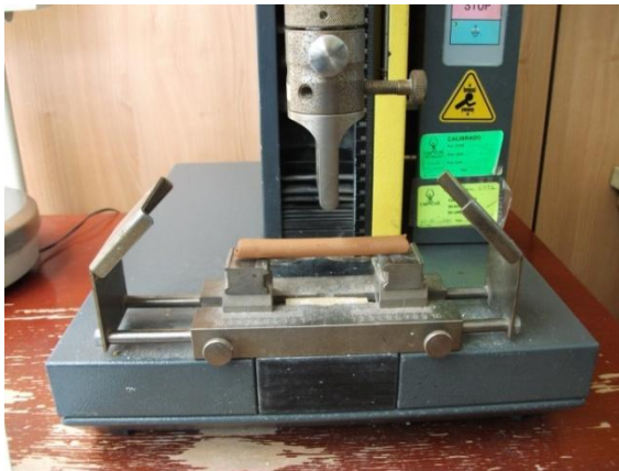
Fig. 8.32 – Prensa Zwick e provete durante o ensaio.
