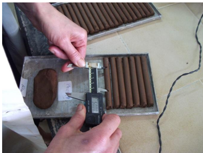
Fig. 8.27 - Marcação dos sulcos, com auxílio de um paquímetro.
