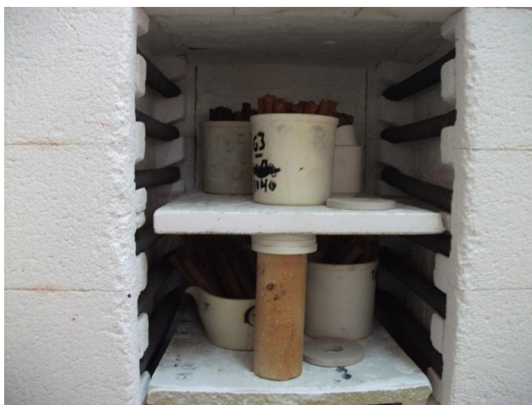
Fig. 9.5 - Conjuntos de provetes no interior do forno elétrico.
