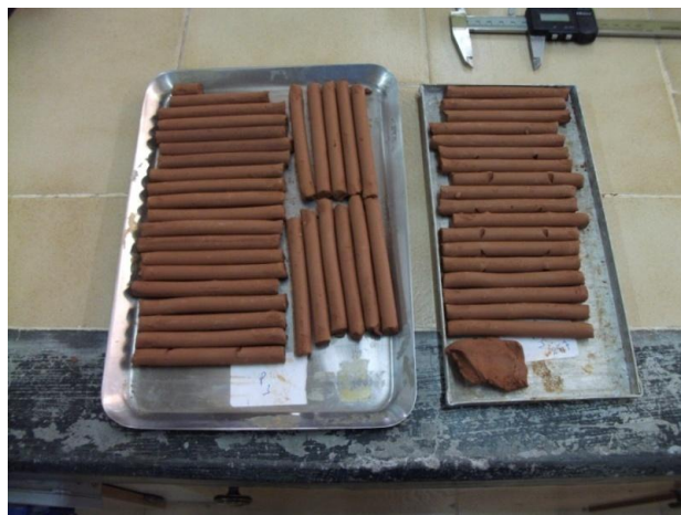
Fig. 10.6 - Provets da pasta nº 3, conformados com dimensões 100 mm x 10 mm.
