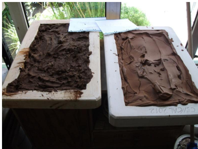
Fig. 8.25 - Secagem parcial das amostras em moldes de gesso.
