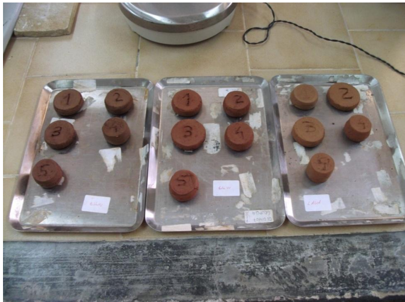
Fig. 9.8 - Provetes obtidos através do ensaio do método de Pfefferkorn.
