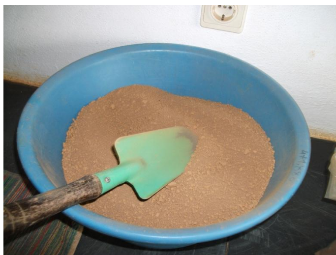
Fig. 8.11 – Material utilizado no segundo corte granulométrico a 250 \mu\text{m} .
