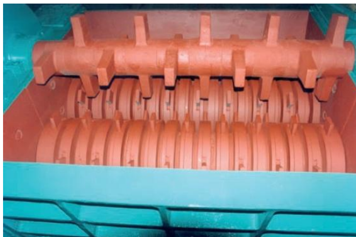
Fig. 13.4 - Conjunto de cilindros equipados com navalhas cortantes.
