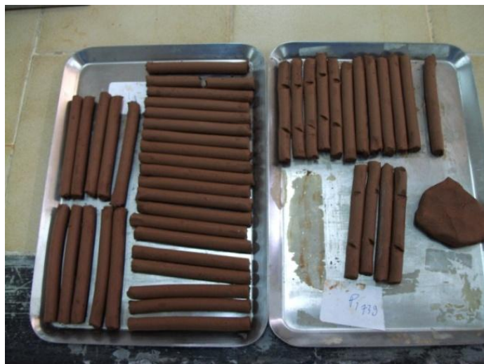
Fig. 10.4 – Provetes da pasta nº 1, conformados com dimensões 100 mm x 10 mm.
