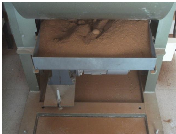
Fig. 8.8 – Amostra desagregada por desgaste no Moinho de Los Angeles da empresa “Tecnovia”.
