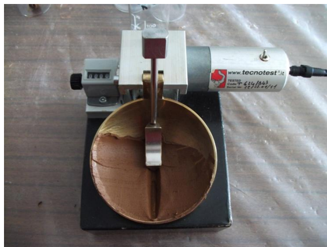
Fig. 8.17 - Concha de Casagrande mostrando o sulco perpendicular à superfície da concha.
