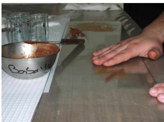
Fig. 8.19 – Execução de um filamento, por rolamento.
