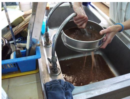
Fig. 8.34 - Execução do ensaio de cálculo da percentagem de resíduo no peneiro de 45 \mu\text{m} .
