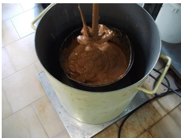
Fig. 10.1 - Homogeneização da pasta cerâmica no agitador mecânico vertical.
