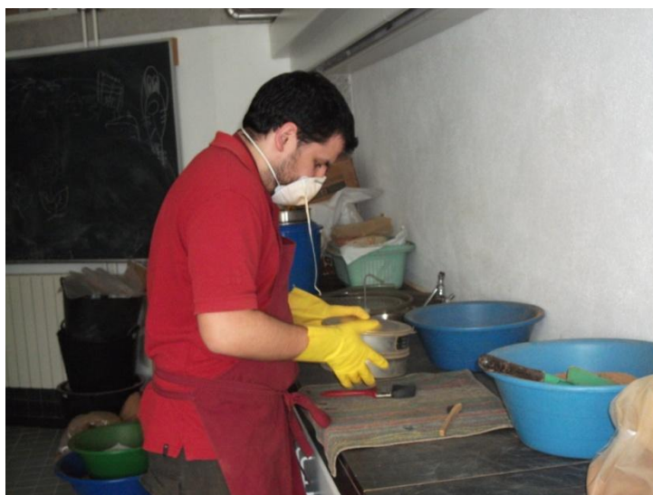
Fig. 8.10 - Corte granulométrico a 250 \mu\text{m} por via seca.
