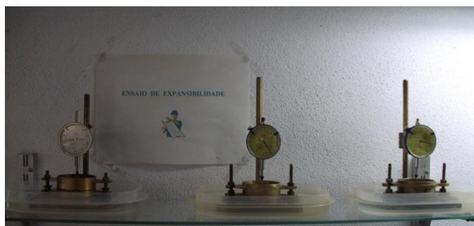
Fig. 8.22 - Recipientes, contendo os defletómetros e as três amostras ensaiadas.
