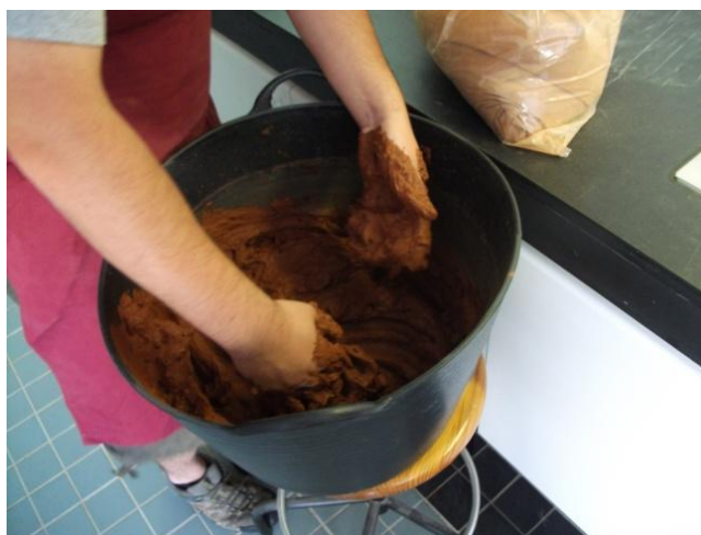
Fig. 8.38 – Homogeneização manual da amostra Biblio VV.
