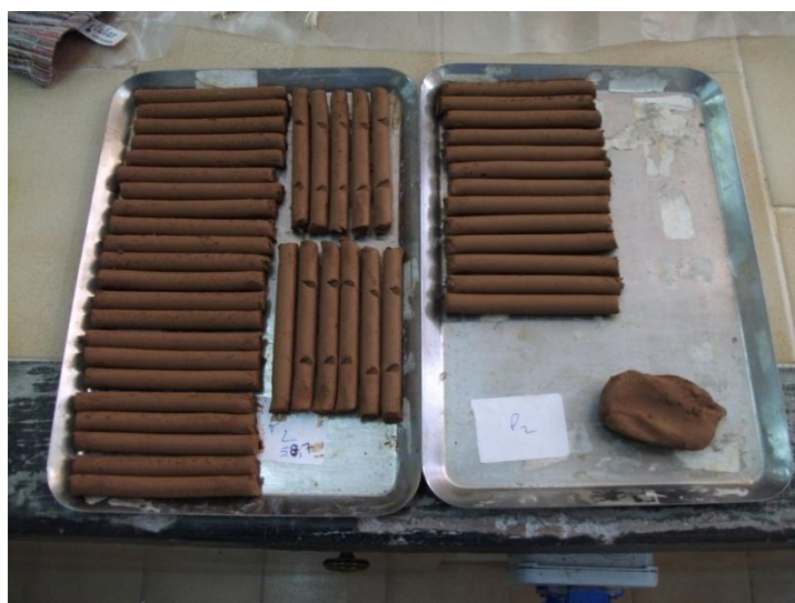
Fig. 10.5 - Provetes da pasta nº 2 conformados com dimensões 100 mm x 10 mm.
