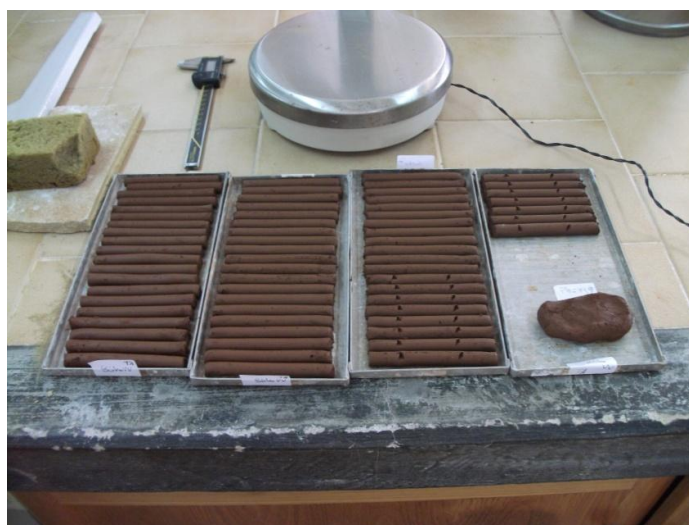
Fig. 8.28 - Provetes extrudidos da amostra Biblio VV, com dimensões 100 mm x 10 mm.
