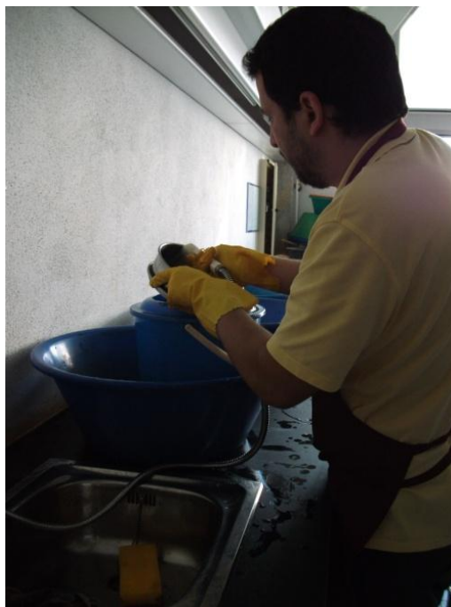
Fig. 8.12 – Corte granulométrico a 250 \mu\text{m} por via húmida.
