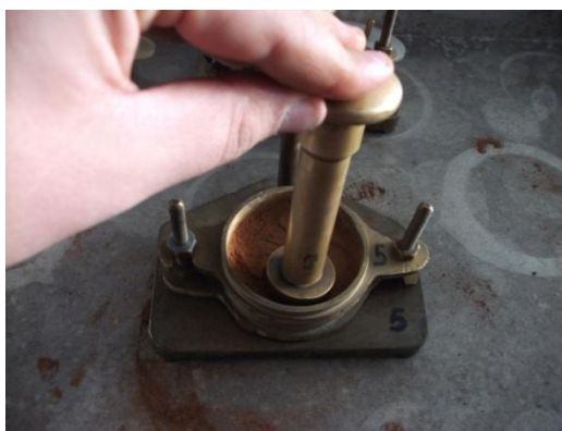
Fig. 8.20 - Compactação do solo no interior do molde, com o auxílio de um pilão.
