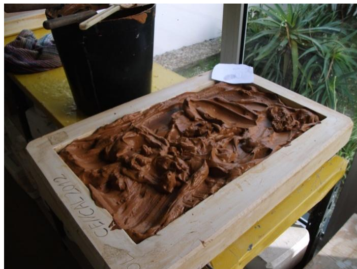
Fig. 10.12 - Desidratação da pasta cerâmica nº 4 em placas de gesso.
