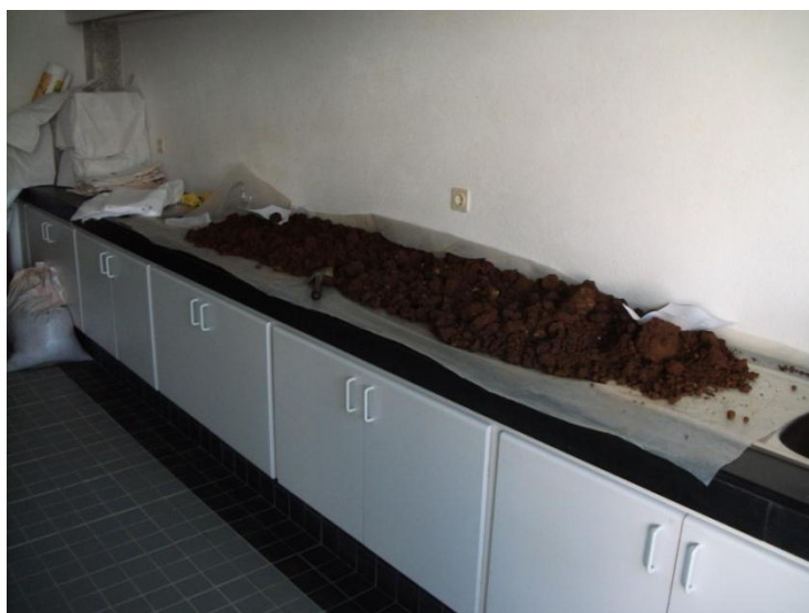
Fig. 8.7 - Amostra Biblio VV em secagem, no Laboratório do Departamento de Geociências.
