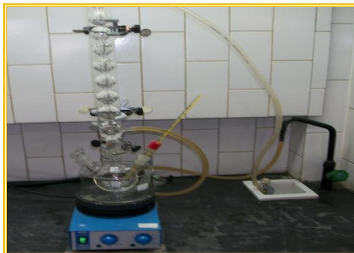
**Figura 19 - Montagem do equipamento para a experiência da despolimerização do PET**
