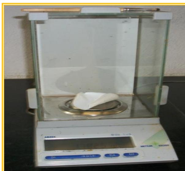
**Figura 23 - Pesagem da massa do ácido tereftálico recuperado**
