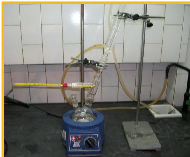
**Figura 27 - Montagem do equipamento para a experiência da polimerização do PET ( 1ª parte)**
