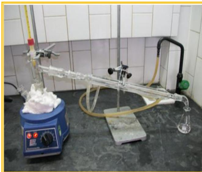
**Figura 30 - Alteração da disposição do aparelho de refluxo e recolha do destilado**
