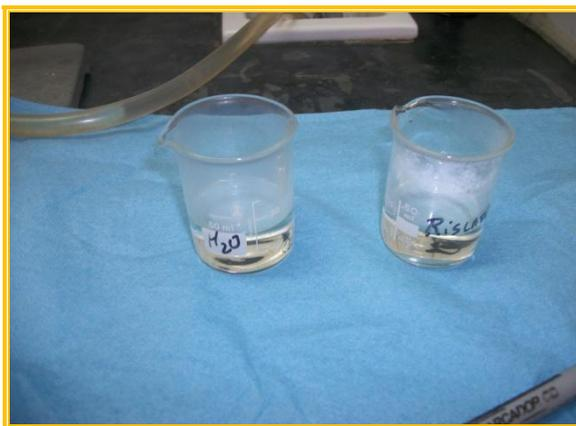
**Figura 31 - Divisão da solução em dois volumes iguais para indução do processo de cristalização “por risco no vidro” ou “adição de água destilada”.**
