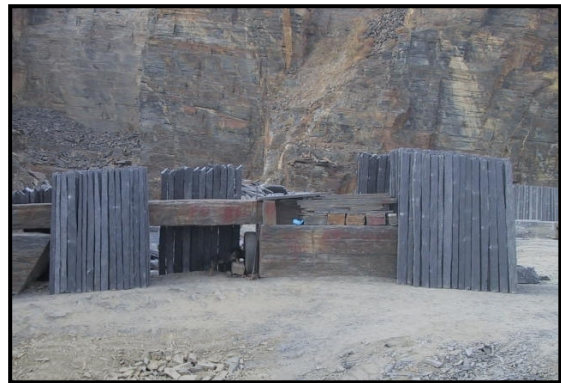
Fig. 7 – Esteios produzidos nas pedreiras do Poio
