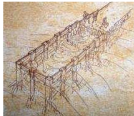
Fig.20 e 21 – Representações de processo construtivos de portos artificiais, com base nas descrições da obra de Vitruvio . À esquerda cofragem dupla, cujo processo construtivo incluía dragar, escavar e finalmente encher de “cimento”; á direita cofragem simples com enchimento de pozolana.
