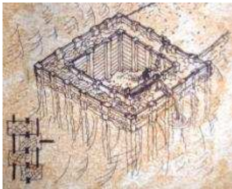
Fig.20 e 21 – Representações de processo construtivos de portos artificiais, com base nas descrições da obra de Vitruvio . À esquerda cofragem dupla, cujo processo construtivo incluía dragar, escavar e finalmente encher de “cimento”; á direita cofragem simples com enchimento de pozolana.
