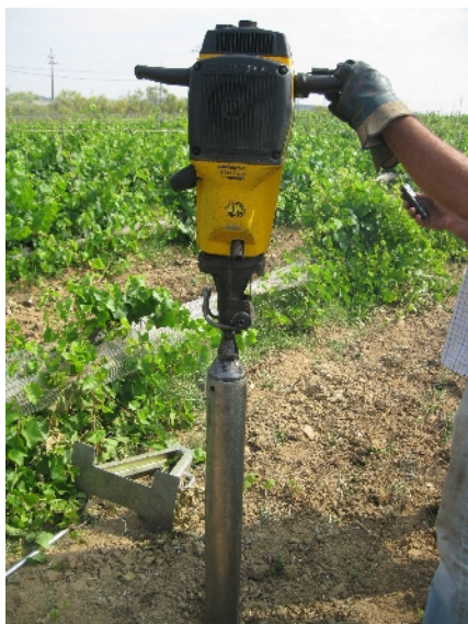
Figura 47 – Perfuração do solo com a sonda.
