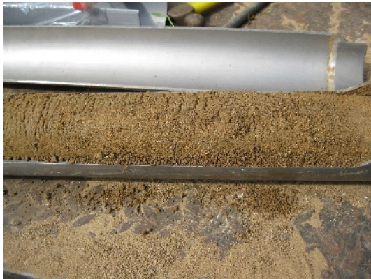
Figura 50 – Monólito na calha plástica.
