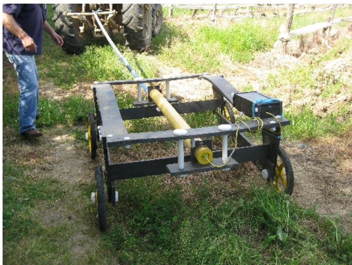
Figura 54 – Montagem do sensor de condutividade eléctrica DUALEM e seu acoplamento ao tractor vinhateiro gentilmente cedido pela “Herdade dos Coelhoiros”.
