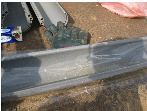
Figura 48 – Calha para colocação dos monólitos, previamente forrada com papel aderente.
