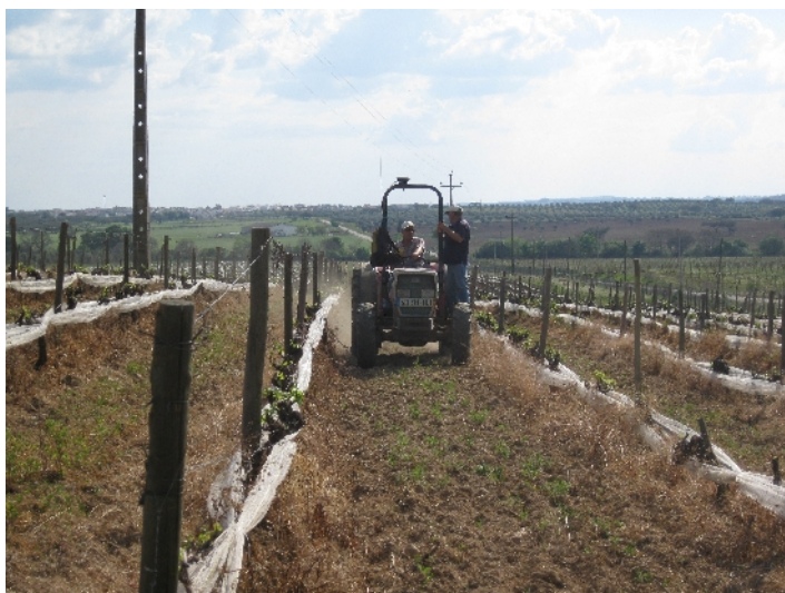
Figura 55 – Tractor vinhateiro a percorrer as entrelinhas com sensor DUALEM acoplado e GPS a 12 de Abril de 2010.
