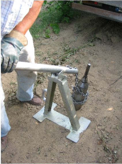
Figura 49 – Sonda a ser retirada do solo após perfuração total.
