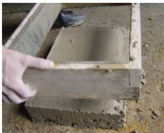
Figura 2.8 - Molde de madeira utilizado na produção de adobe [Moreira, 2008] Figura 2.9 - Desmoldagem de adobe [Moreira, 2008]
