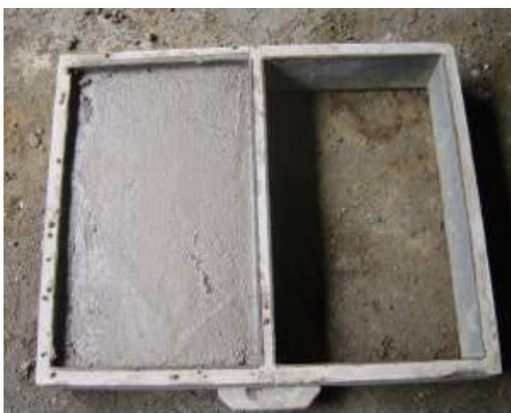
Figura 2.8 - Molde de madeira utilizado na produção de adobe [Moreira, 2008] Figura 2.9 - Desmoldagem de adobe [Moreira, 2008]
