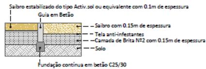
**PORMENOR CONSTRUTIVO PAVIMENTO 2: SAIBRO ESTABILIZADO**
