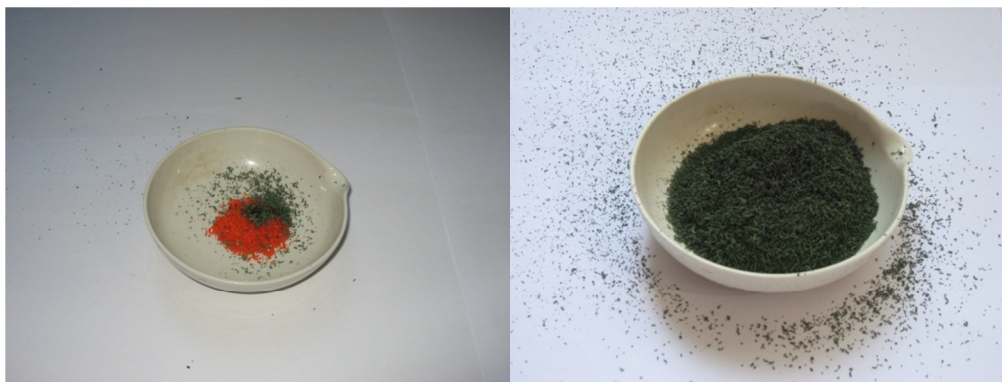
Figura 9 - Vulcão químico e resíduos de \text{Cr}_2\text{O}_3 produzidos. 15
