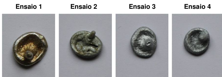
Figura 27 – Amostras de zinco após a cromagem.
