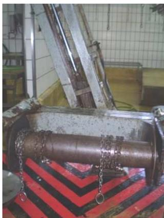
Fig. 25 Máquina de esfola dos bovinos (C. Bento 2010)
