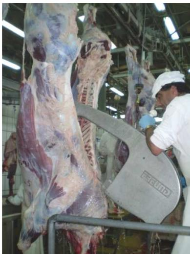
Fig. 27 A serra mecânica para divisão da carcaça dos bovinos (C. Bento 2010)
