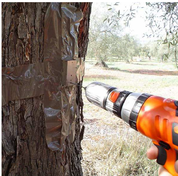
Figura 9: Execução dos orifícios para a instalação das sondas HPV com uma peça-guia que garante a precisão das distâncias entre os orifícios.
