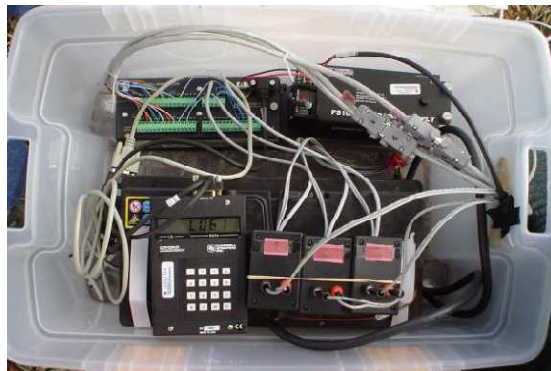
Figura 11: Datalogger e equipamento usado para controlar as sondas e acumular os dados de t_z , a partir dos quais se calcula o fluxo de seiva.
