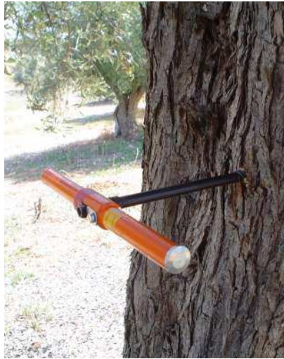
Figura 16: Obtenção de amostras de madeira do tronco para determinar a espessura da zona de circulação da seiva (sapwood) e das fracções de madeira e água da madeira.
