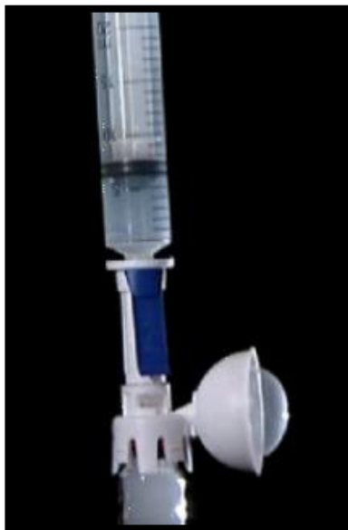
Figura 15: Sistema PhaSeal® da Carmel Pharma evidenciando a ausência de fuga de TiCl_4 para o exterior 28 .
