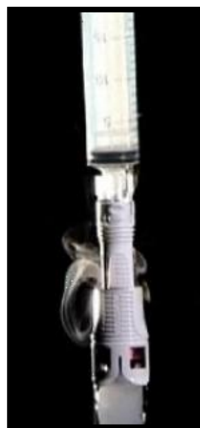
Figura 12: Sistema Tevadaptor®/OnGuard™ da Teva Medical/B. Braun Medical evidenciando a fuga de \text{TiCl}_4 para o exterior 28 .
