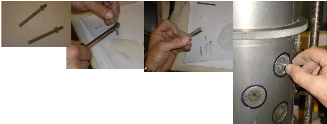
Fig. 33 – Colocação dos fixadores dos apoios dos transdutores.
