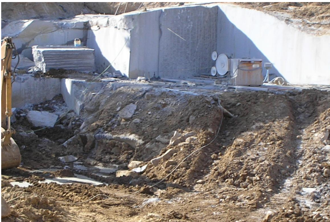
Foto 4.11 Máquina de fio FDP 50SG na Pedra Secular, Lda
