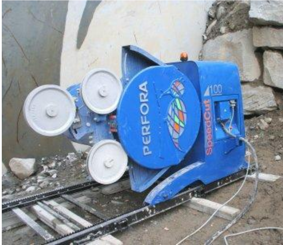
Foto 4.16 Máquina de fio diamantado speedcut 100 Perfora
