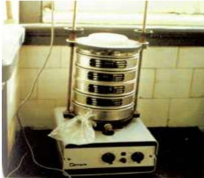
**Figura 4.8-** Agitador mecânico utilizado para a determinação das análises granulométricas.
