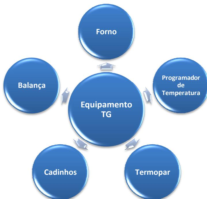
**Figura 1.22** – Componentes do equipamento de Termogravimetria [12].
