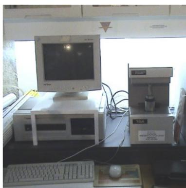
**Figura 2.1** – Equipamento TGA.
