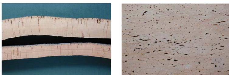
**Figura 1.6** – Cortiça em corte transversal (à esquerda) e tangencial (à direita), onde são visíveis os canais lenticulares que atravessam a cortiça, constituindo a sua porosidade natural [9].
