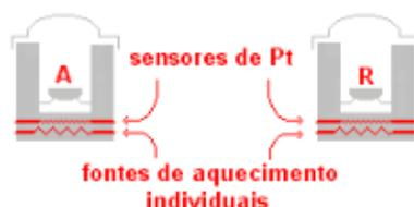
**Figura 1.11** – Esquema dos compartimentos do DSC por compensação de energia [12].
