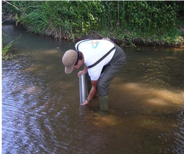
Figura 16- Recolha de amostra de sedimento com corer para análise granulométrica.
