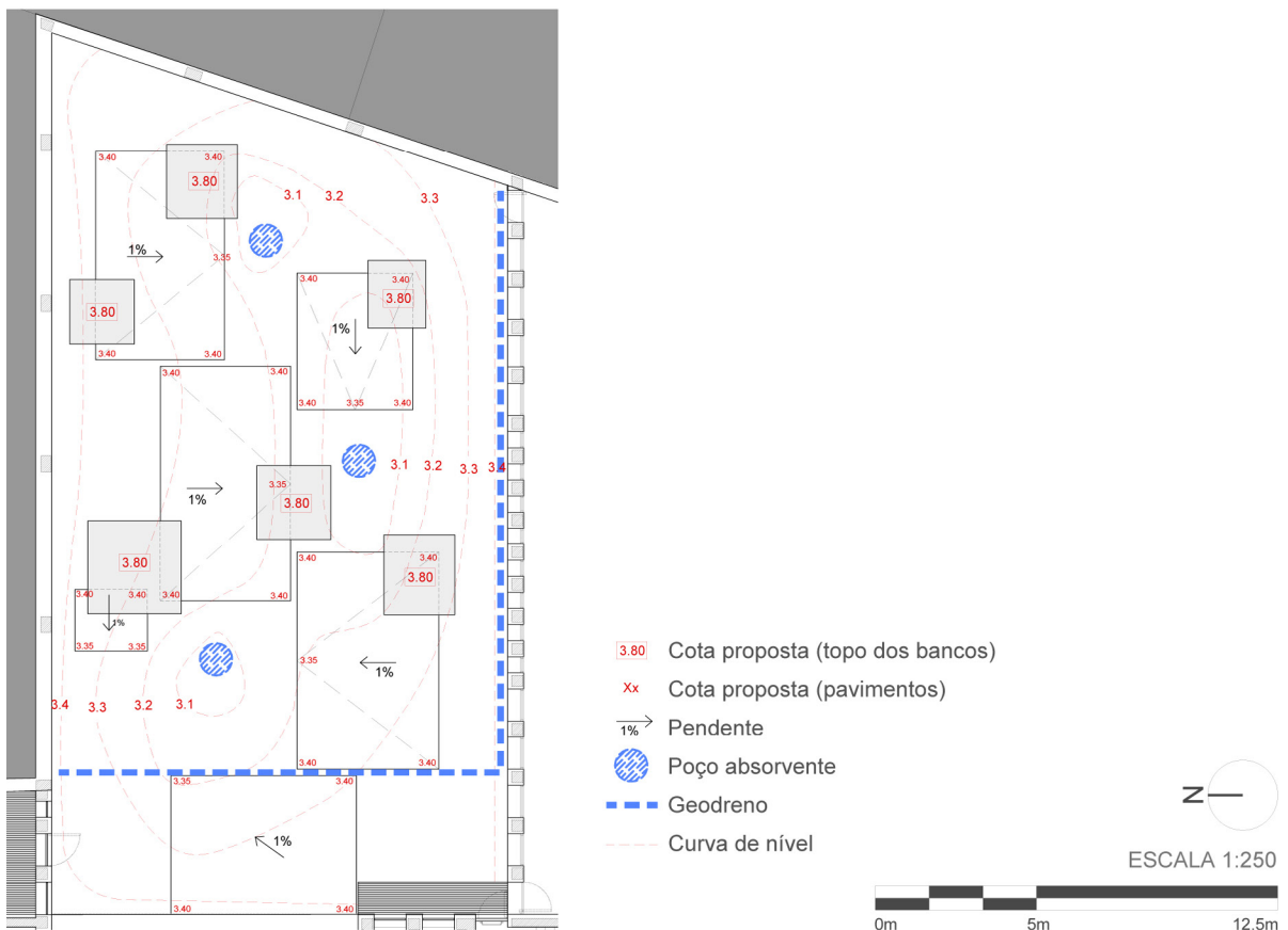
Figura 49 - Planta de altimetria e drenagem. Fonte: PROAP.
