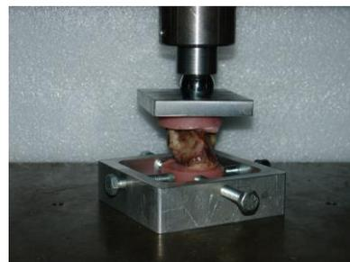
Fig. 3 Realização dos testes mecânicos de compressão.
