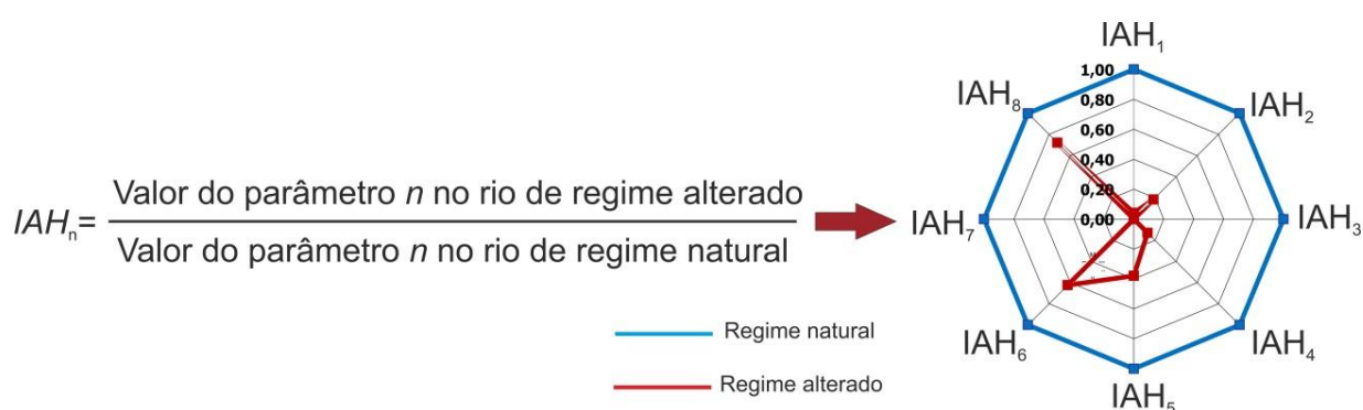
Figura 4: Fórmula de cálculo da análise IARHIS e exemplo de resultado da mesma.
