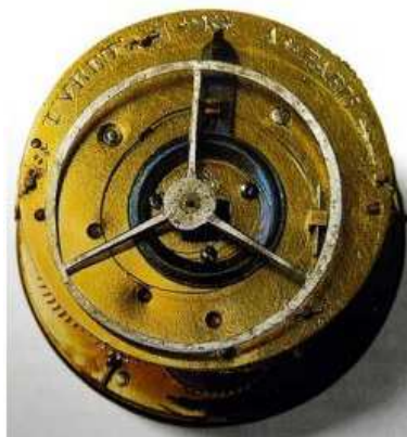
Figura 2.5: Provavelmente o primeiro relógio com espiral feito por Thuret para Huygens
