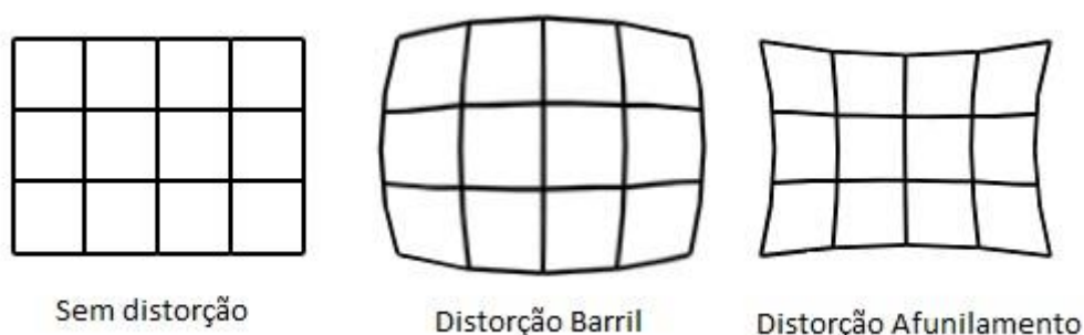
Figura 34 - Distorções Radiais produzidas nas fotografias pelas lentes das objetivas
