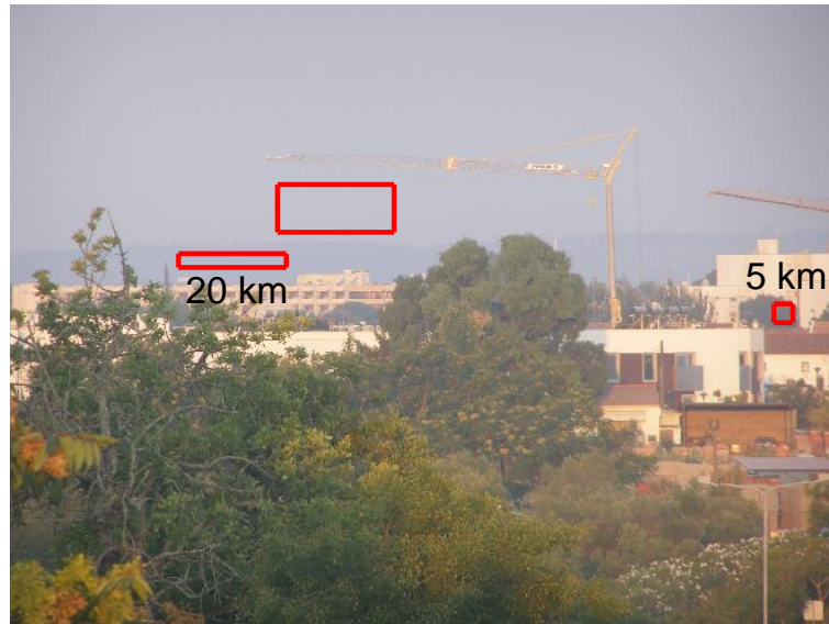
Figura 59 - Campo de visão da máquina fotográfica instalada em Évora, onde estão presentes os objetos naturais utilizados para o cálculo da visibilidade atmosférica.
