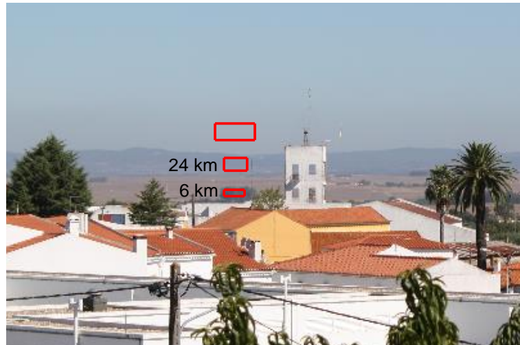
Figura 52 - Campo de visão da máquina fotográfica instalada em Viana do Alentejo, onde estão presentes os objetos naturais utilizados para o cálculo da visibilidade atmosférica.
