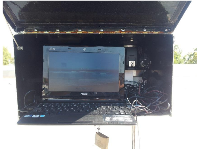
Figura 17 - Caixa protetora dos componentes do sistema de medição.
