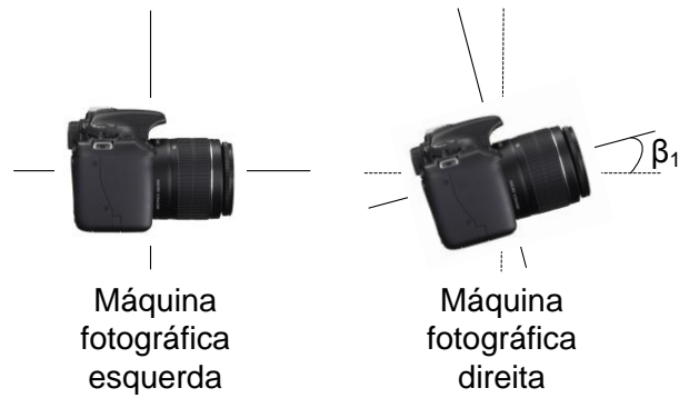
Figura 25 - Desalinhamento causado pela rotação \beta_1 .
